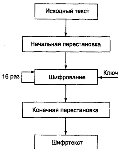
Рис. 6.2. Обобщенная схема шифрования в алгоритме DES
