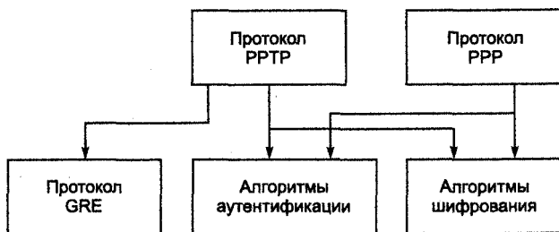
Рис. 11.2. Архитектура протокола PPTP
