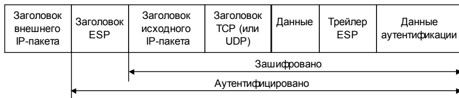
Рис. 8.15. IP-пакет после применения протокола ESP в транспортном и туннельном режимах
