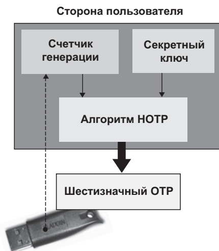
Рис. 11.4. Пример генерации одноразовых паролей на стороне пользователя
