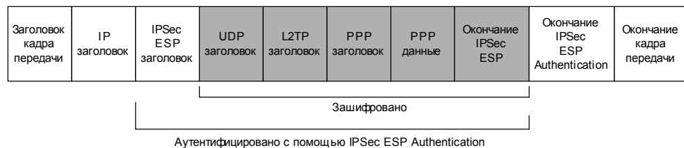
Рис. 8.8. Структура пакета для пересылки по туннелю L2TP
