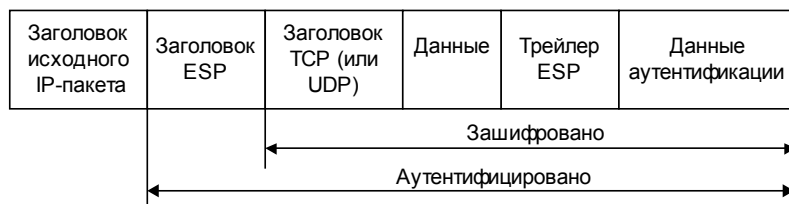
IP-пакет после применения протокола ESP в туннельном режиме
