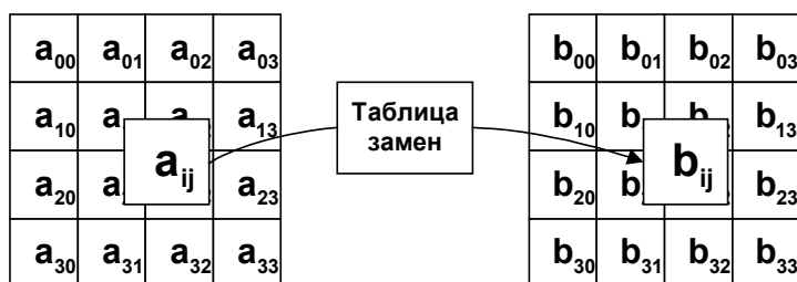
Рис. 4.9. Преобразование BS (ByteSub) использует таблицу замен (подстановок) для обработки каждого байта массива State
