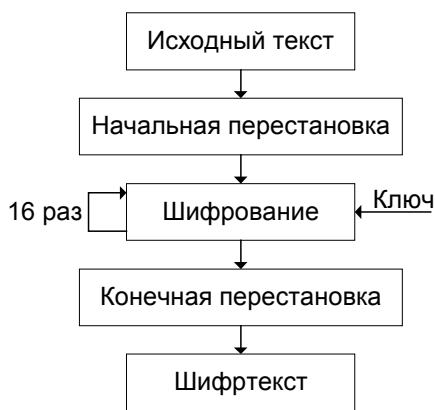
Рис. 4.5. Обобщенная схема шифрования в алгоритме DES
