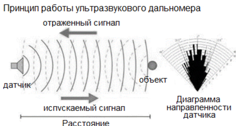
Рис. 2.38. Принцип работы ультразвукового дальномера
