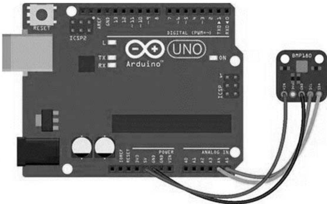
Рис. 2.30. Монтажная схема подключения датчика BMP-180 к контроллеру
