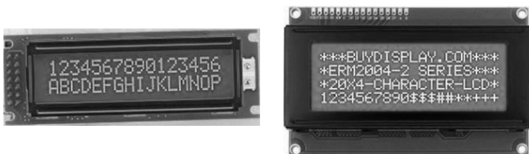
Рис. 2.19. Двух- и четырехстрочный жидкокристаллические дисплеи
