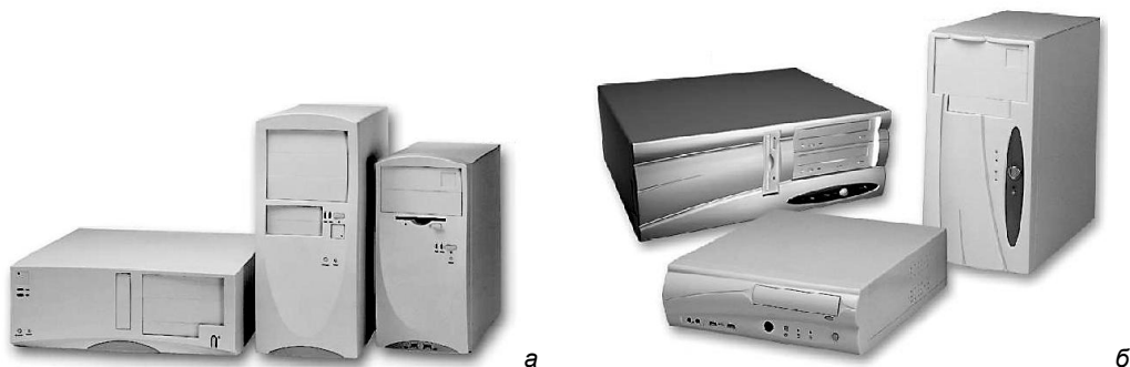
Рис. 2.4. Пример сравнения габаритов различных видов корпусов производства компании Denco: а — Desktop, Midi Tower и Mini Tower; б — Desktop, Mini Desktop и Mini Tower
