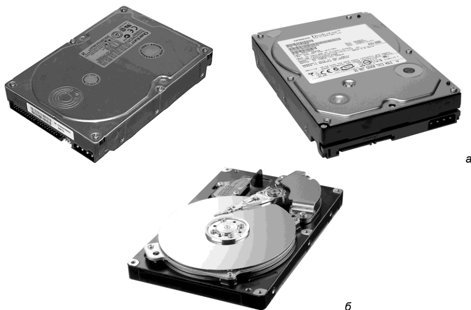
Рис. 6.2. а — внешний вид винчестера: Quantum (IDE) (слева) и Hitachi (SATA) (справа); б — внутреннее устройство винчестера SpinPoint P80 Serial ATA (SATA) производства корпорации Samsung
