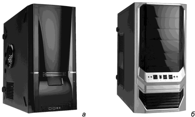
Рис. 2.6. Корпуса ATX компании In Win: а — Midi Tower C-серии; б — Midi Tower J-серии
