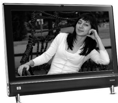
Рис. 2.1. Корпуса компьютеров типа "все в одном" с сенсорным экраном: а — VPCJ21S1R серия J производства корпорации Sony (процессор Intel Core i3 второго поколения); б — HP TouchSmart 600-1130ru производства корпорации HP (процессор Intel Core 2 Duo)
