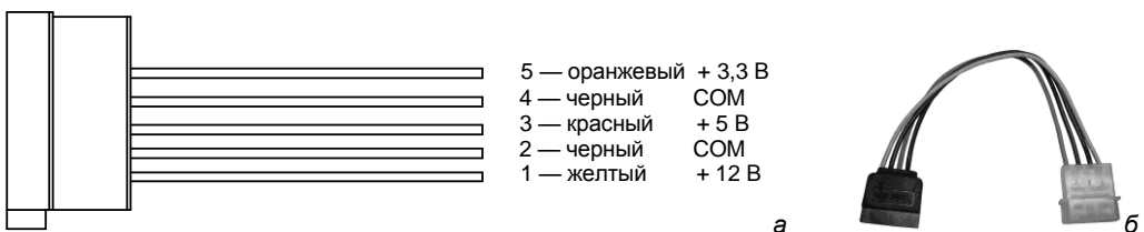
Рис. 2.23. Интерфейс Serial ATA: а — разводка разъема для питания винчестеров; б — переходник для питания винчестеров
