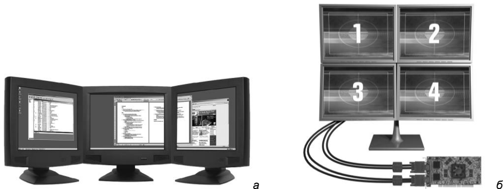
Рис. 10.5. Мультимониторные системы: а — распределение рабочего стола на три монитора при использовании видеокарты компании Matrox Parhelia; б — видеокарта Matrox Parhelia HR256 и видеостенка из четырех мониторов
