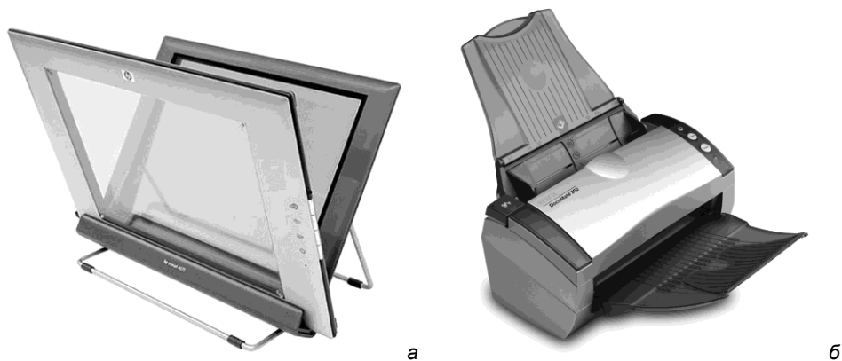
Рис. 9.5. Планшетные сканеры для документов: а — "прозрачный" вертикальный сканер HP Scanjet 4670; б — поточный документ-сканер Xerox DocuMate 252
