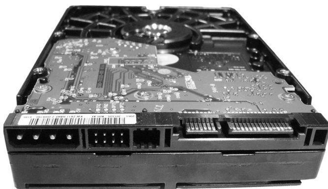
Рис. 6.15. Винчестер с интерфейсом SATA и дополнительным разъемом питания Molex
