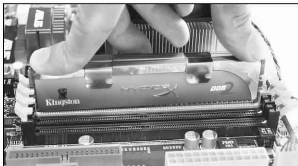
Рис. 12.20. Срабатывание защелок фиксации модуля памяти (момент срабатывания левой, правая пока еще открыта)
