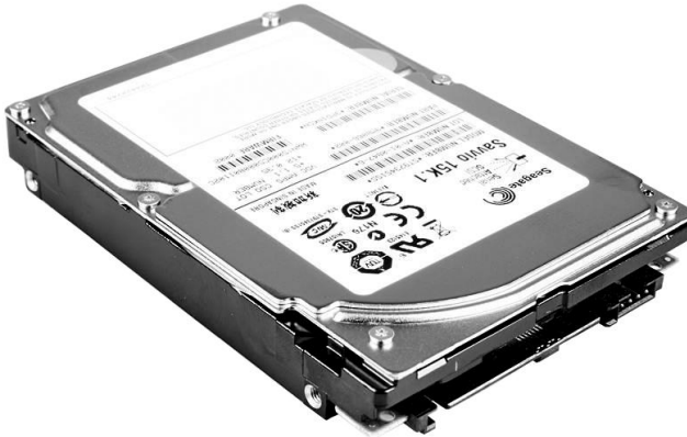
Рис. 6.8. Винчестер корпорации Seagate с интерфейсом SAS
