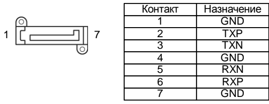
Рис. 6.12. Назначение контактов информационного разъема SATA на системной плате
