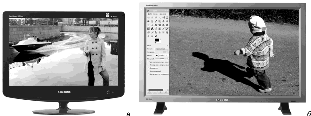
Рис. 1.24. Мониторы производства корпорации Samsung: а — плоский жидкокристаллический дисплей форм-фактора 4:3; б — плоский жидкокристаллический дисплей форм-фактора 16:9
