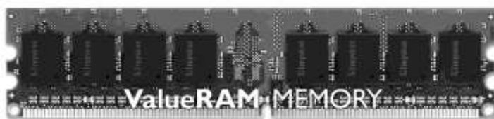
Рис. 5.5. 240-контактный модуль DDR2 SDRAM производства компании Kingston
