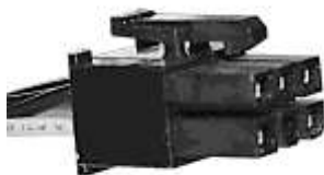
Рис. 2.15. Дополнительный разъем блока питания для питания видеокарты форм-фактора PCI-E 16x
