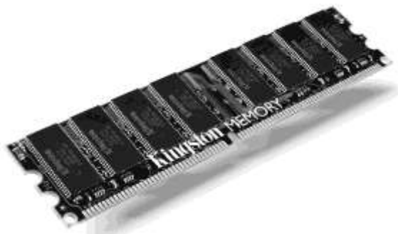
Рис. 5.3. 184-контактный модуль DDR400 SDRAM производства компании Kingston
