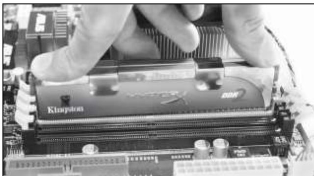
Рис. 12.21. Срабатывание защелок фиксации модуля памяти (момент срабатывания левой, правая еще открыта)
