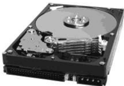
Рис. 6.6. Винчестеры корпорации Hitachi с интерфейсом (гермоблок открыт): а — IDE; б — SATA
