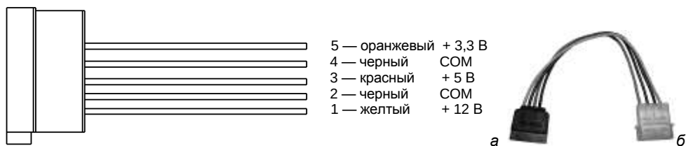
Рис. 2.16. Интерфейс Serial ATA: а — разводка разъема для питания винчестеров; б — переходник для питания винчестеров
