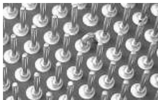
Рис. 12.6. Загнутые выводы процессора Athlon 64 FX в середине контактного поля
