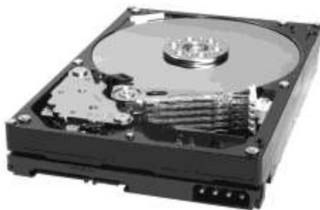
Рис. 6.6. Винчестеры корпорации Hitachi с интерфейсом (гермоблок открыт): а — IDE; б — SATA
