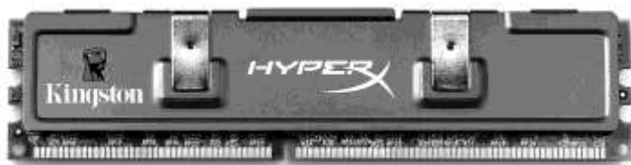
Рис. 1.30. Модуль оперативной памяти (с радиатором охлаждения микросхем)
