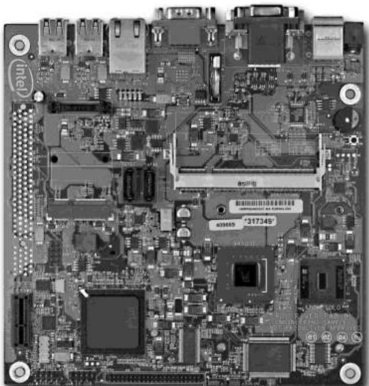
Рис. 4.17. Системная плата с процессором Atom N270 и чипсетом Intel 945GSE Express
