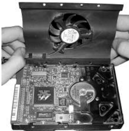
Рис. 12.53. Установка охлаждающего устройства на винчестер
