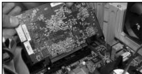
Рис. 12.39. Установка видеокарты: а — в слот AGP; б — в слот PCI Express
