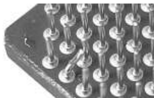
Рис. 12.7. Загнутые выводы процессора Athlon 64 FX на краю корпуса
