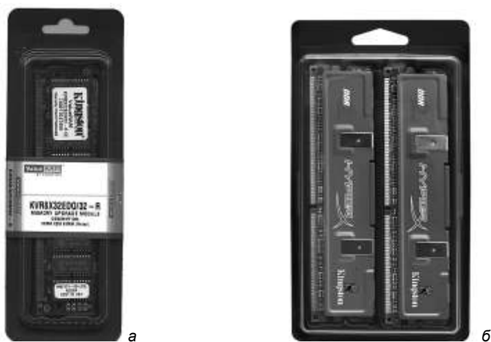
Рис. 5.9. Пластиковый контейнер: а — для одиночного модуля памяти; б — для двух модулей памяти, протестированных для двухканального режима
