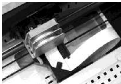
Рис. 8.2. Печатающая головка матричного принтера EPSON LX-300+
