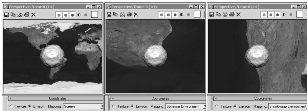
Рис. 13.20. Иллюстрация влияния проекционных координат на изображение текстурного фона
