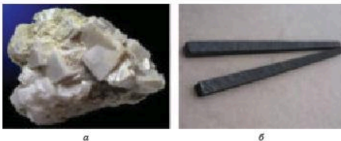
Рис. 70. Вспомогательные материалы для производства алюминия: а — криолит; б — угольные стержни
