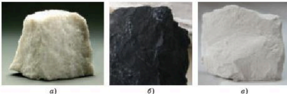
Рис. 64. Вспомогательные материалы для производства чугуна: а) доломит; б) кокс; в) известняк
