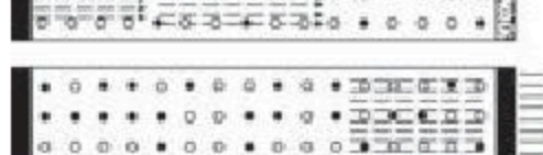
Рис. 55.4. Образование лавины фотонов в рубиновом цилиндре
