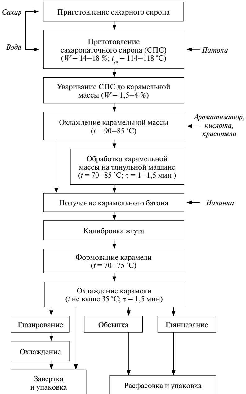
Рис. 3.1. Структурная схема производства карамели с жидкой начинкой
