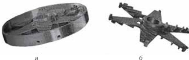
Рис. 9.20. Модуль (а) и мешалка (б) машины АМС
