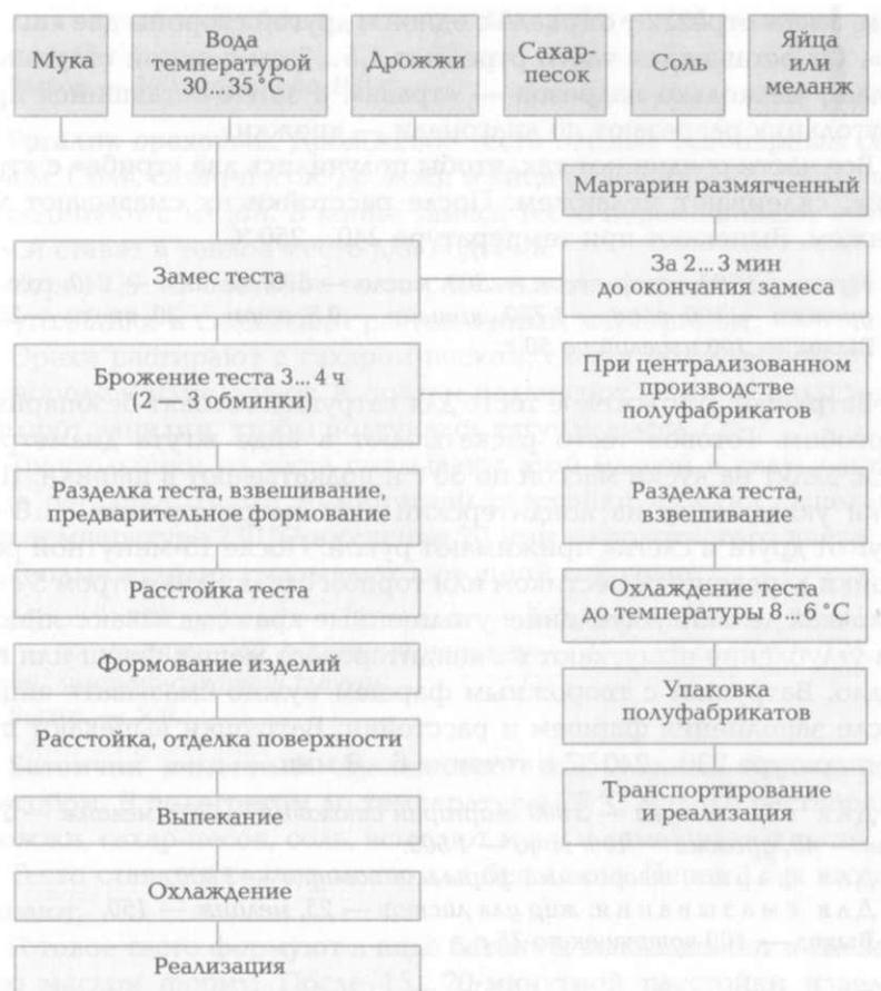
Рис. 5.3. Технологическая схема приготовления изделий из дрожжевого теста, приготовленного безопасным способом
