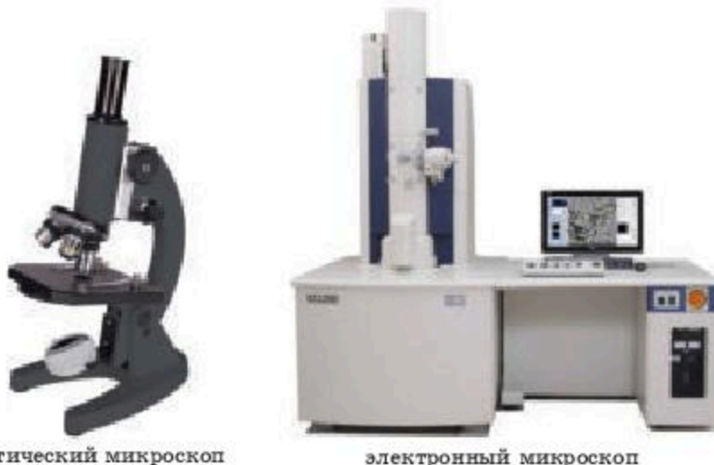
Рис. 8.6. Оптический и электронный микроскопы
