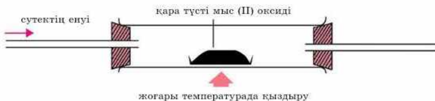
57-сурет. Мыстың тотықсыздануы
