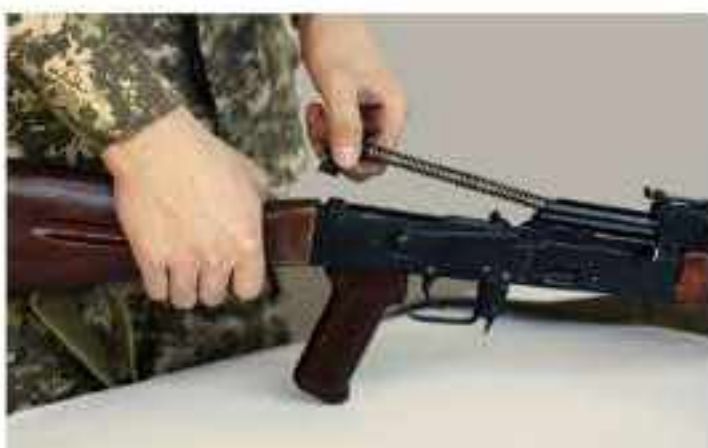
Рис. 12. Отделение возвратного механизма
