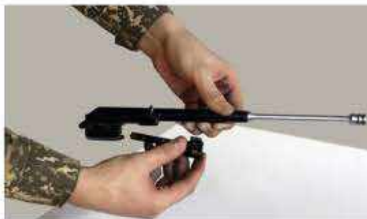
Рис. 14. Отделение затвора от затворной рамы
