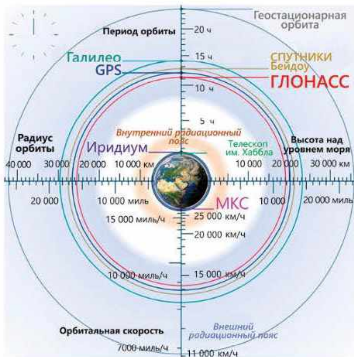
Рис. 60. Сравнение орбит разных спутниковых навигационных систем
