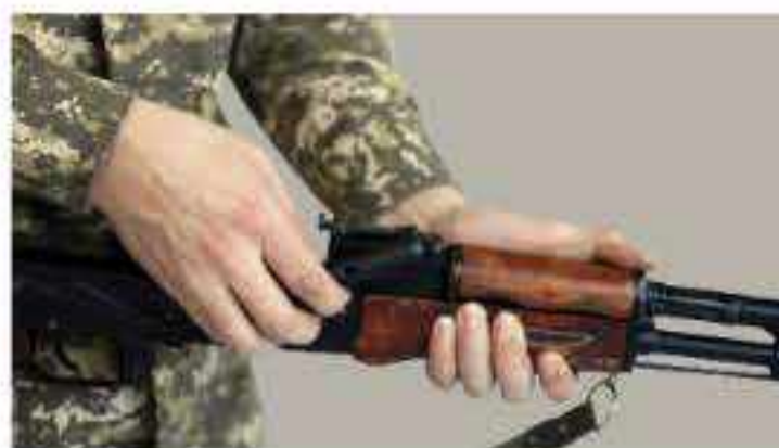
Рис. 15, а. Поворот замыкателя газовой трубки с помощью пенала принадлежностей
