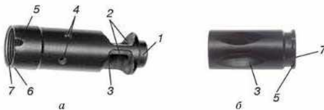
Рис. 19. Дульный тормоз-компенсатор и пламегаситель:
