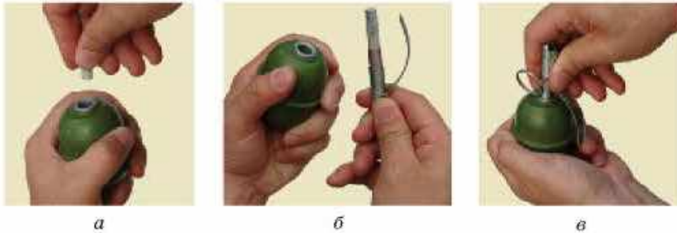
Рис. 41. Заряжание ручной осколочной гранаты:
