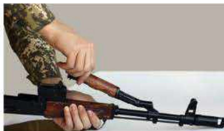
Рис. 15, б. Отделение газовой трубки со ствольной накладкой
