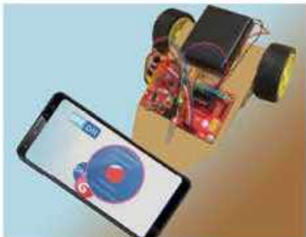
Рис. 72, а. Управление Arduino машинкой при помощи G-сенсора на Android смартфоне
