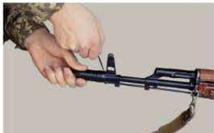
Рис. 10, а. Отделение у автомата дульного тормоза-компенсатора
