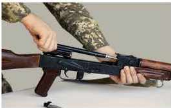
Рис. 13. Отделение затворной рамы с затвором
