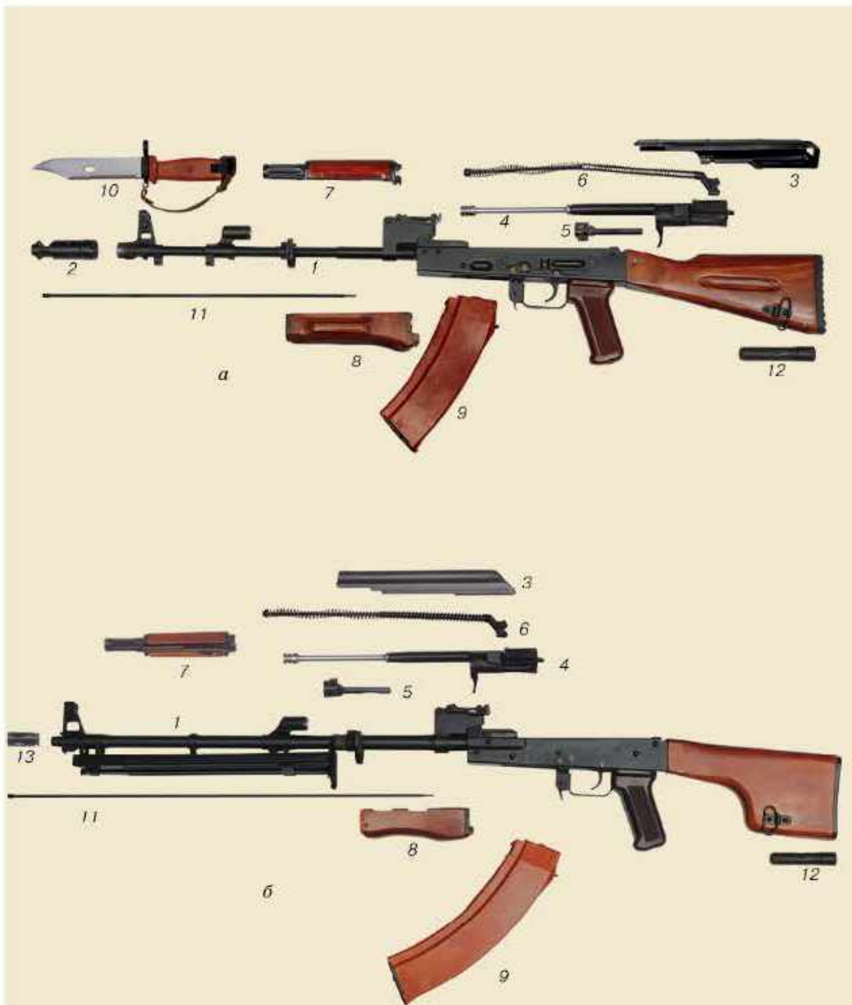
Рис. 6. Основные части и механизмы автомата (пулемета) и его принадлежности: а — автомата; б — пулемета; 1 — ствол со ствольной коробкой, с ударно-спусковым механизмом, прицельным приспособлением, прикладом и pistolетной рукояткой, а у пулемета и с сошкой; 2 — дульный тормоз-компенсатор; 3 — крышка ствольной коробки; 4 — затворная рама с газовым поршнем; 5 — затвор; 6 — возвратный механизм; 7 — газовая трубка со ствольной накладкой; 8 — цевье; 9 — магазин; 10 — штык-нож; 11 — шомпол; 12 — пенал принадлежностей; 13 — пламегаситель
