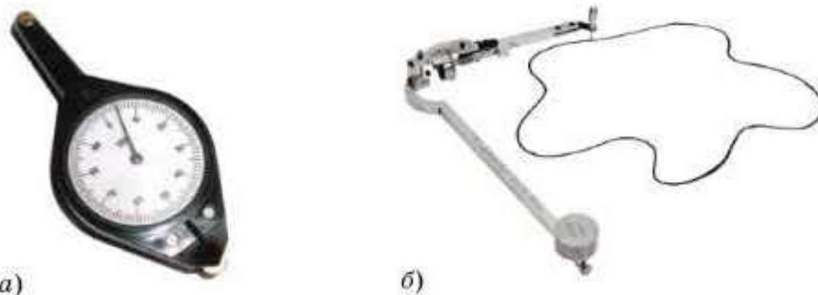
Рис. 15. Картографические приборы: а) курвиметр ; б) планиметр
