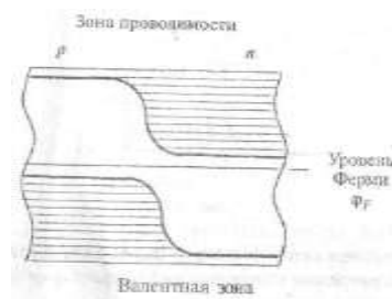
Рисунок 1.5 - Структура p-n - перехода и изучение зонной диаграммы.
