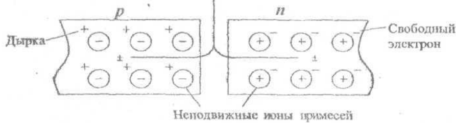
1.2 суреті – Жартылай өткізгіштің бір бірінен окшауланған қабаттары.
