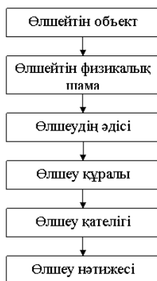
1.1 Сурет. Өлшеу процессінің функциялық сұлбасы
