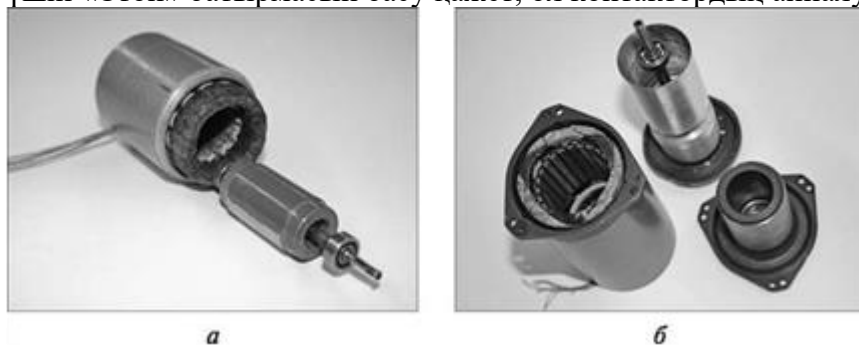
6.10-сурет. Қысқа түйісетін (а) және толық роторлармен (б) қозғалтқыштар
