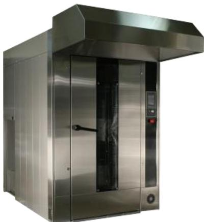
Ротационные печи предназначены для выпечки различных хлебобулочных изделий. Они представляют собой машины внушительных размеров, внутреннее пространство которых называется пекарской камерой. В нее помещается тележка с заготовками теста, которое впоследствии подвергается тепловой обработке. В ротационной печи можно готовить любые кондитерские изделия из сдобного, дрожжевого или замороженного теста.
