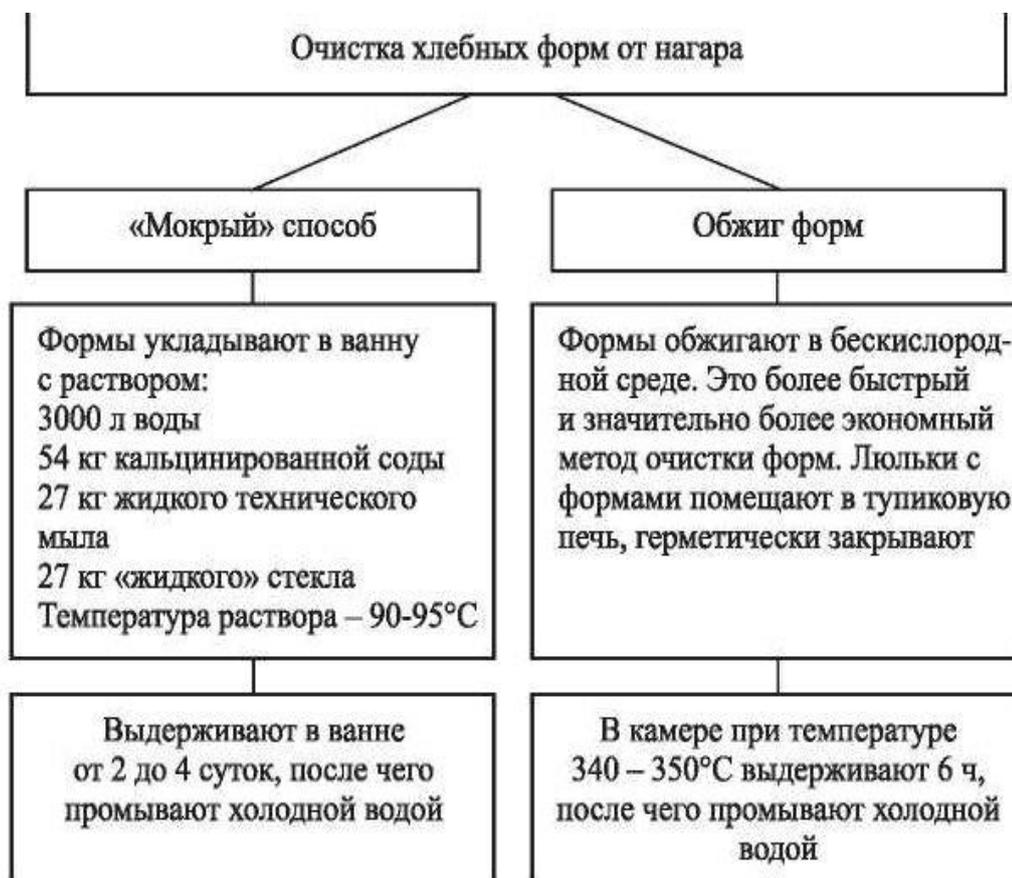
В процессе эксплуатации хлебопекарных форм происходит старение полимерного покрытия и возникает необходимость в удалении обработанного покрытия и нанесение нового.
