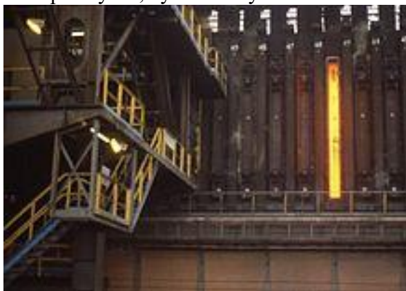
Рис.1. Коксовая печь – технологический агрегат, в котором осуществляется коксование каменного угля
