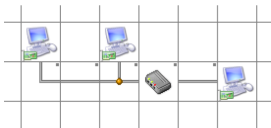
Рис. 6.16. Сеть по топологии Звезда
