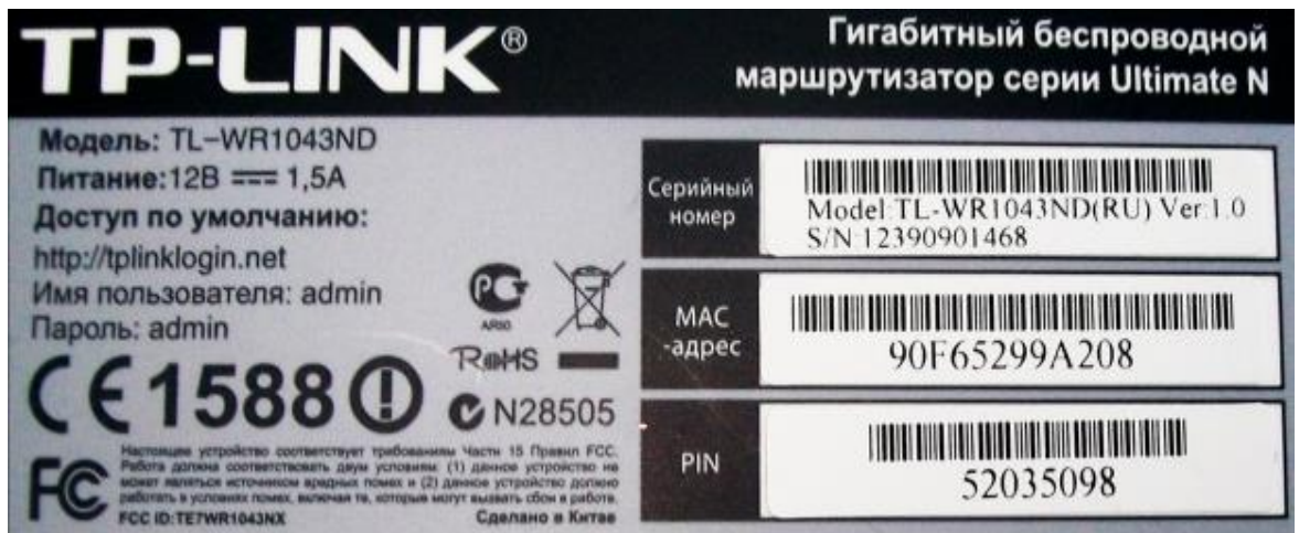
Рис. 9.30. Этикетка роутера с его PIN кодом
