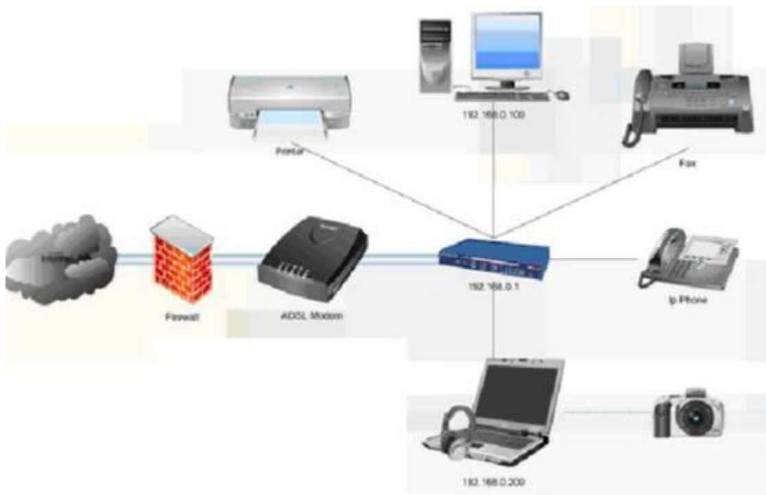
Рис. 4. Схема сети небольшого офиса
