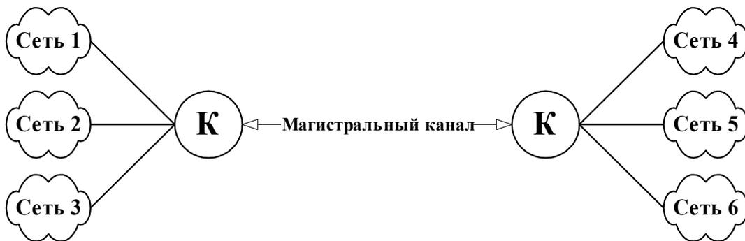
Рис. 10.8 Схема подключения локальных сетей к коммутаторам
