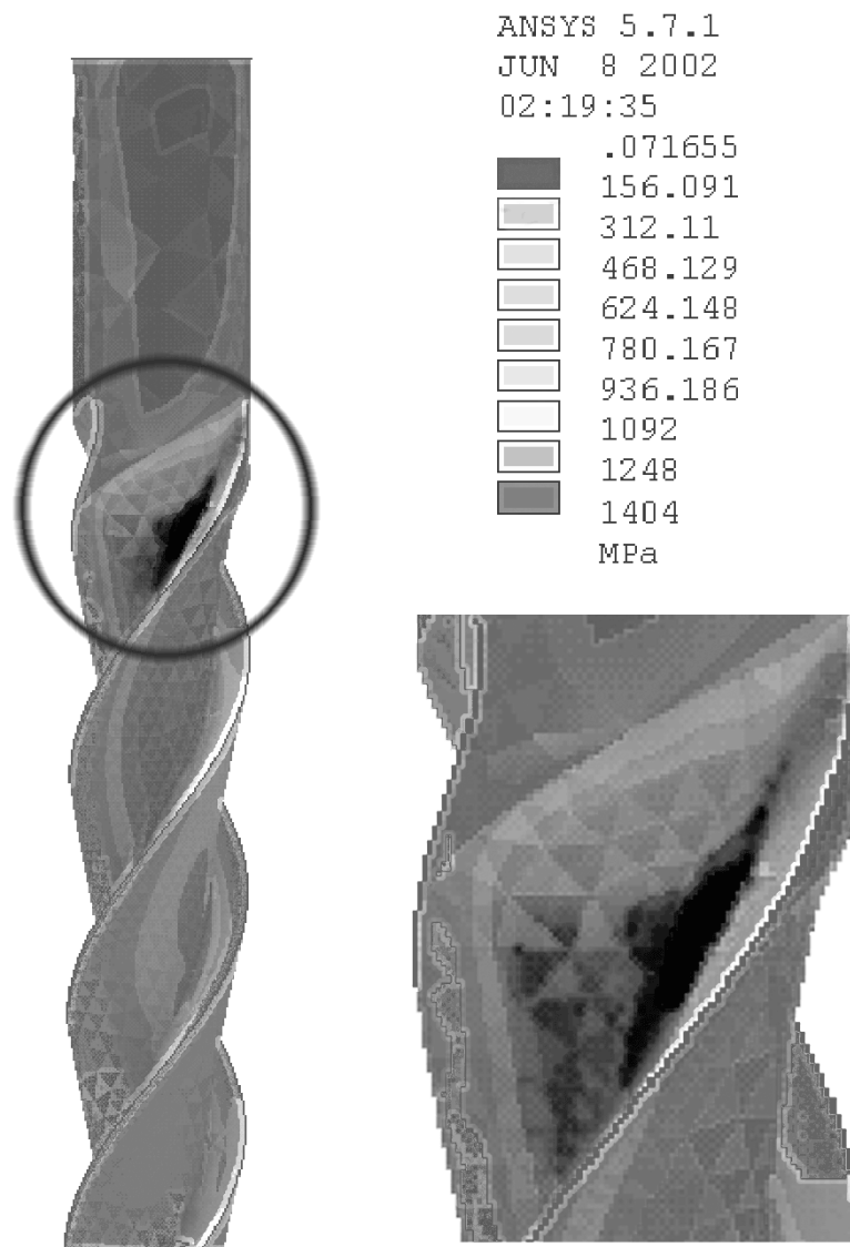
Рис. 3.4. Расчет напряжений возникающих в теле концевой фрезы при резании (ANSYS)
