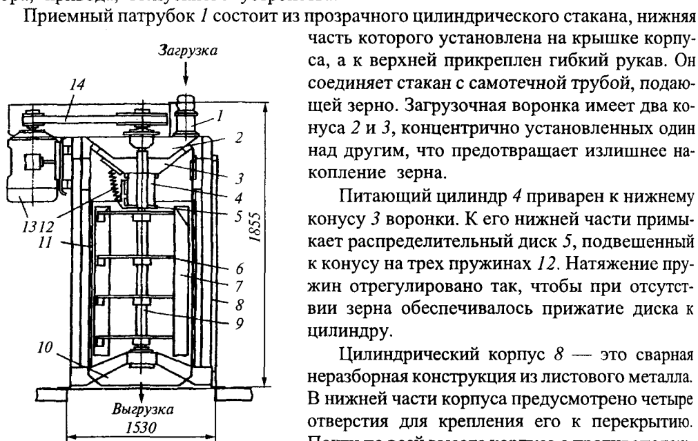
Рис. 8.5. Вертикальная обоечная машина РЗ-БМО-6
