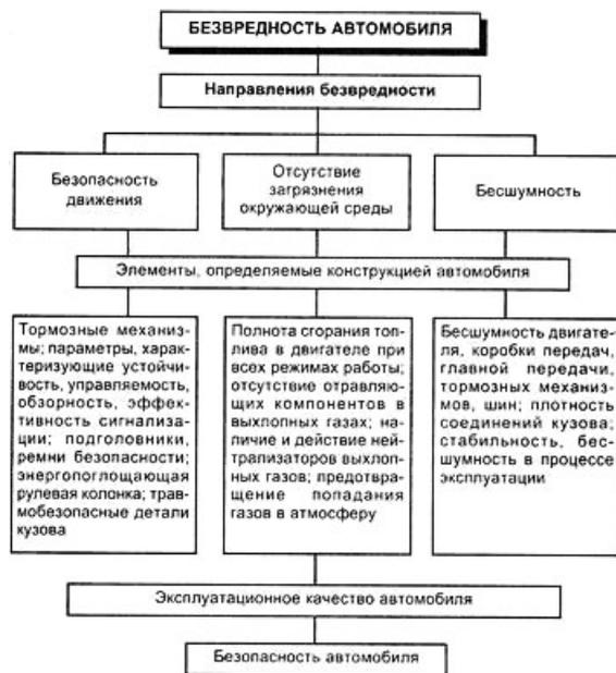
Рисунок 4.3 – Зависимость безвредности автомобиля от его конструкции и эксплуатации (В.В. Амбарцумян, «Экология и жизнь» № 2, 1999 г.)
