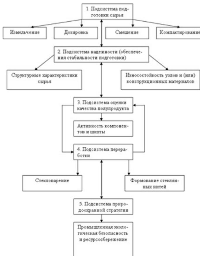
Рисунок 1.9 – Схема системной разработки и усовершенствования ресурсосберегающей техники подготовки и переработки стекольных шихт[4].
