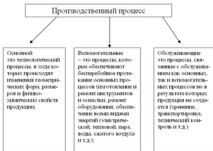
Рисунок 1.1 – Характеристика производственных процессов
