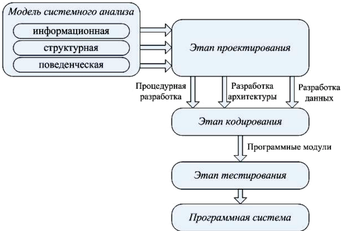
Рис. 4. Модели системного анализа при проектировании ПО
