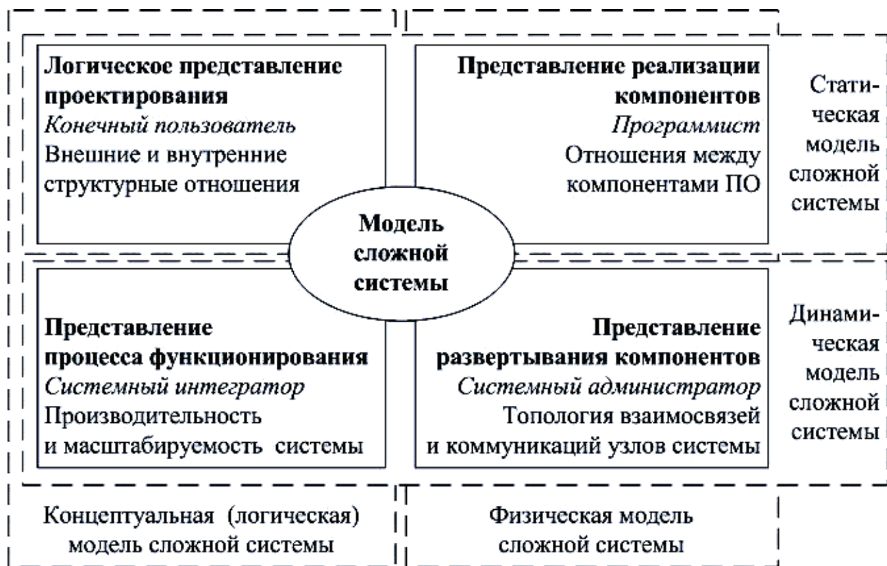
Рис. 21. Общая схема представлений при объектном анализе и проектировании
