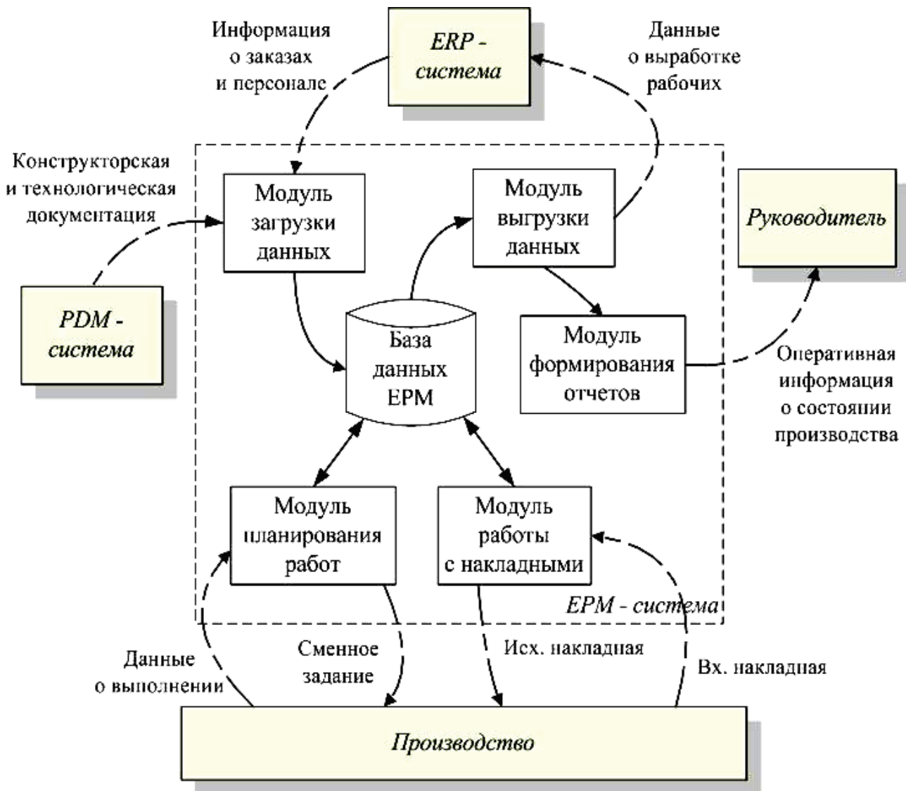
Рис. 10. Логическая программная архитектура ЕРМ-системы
