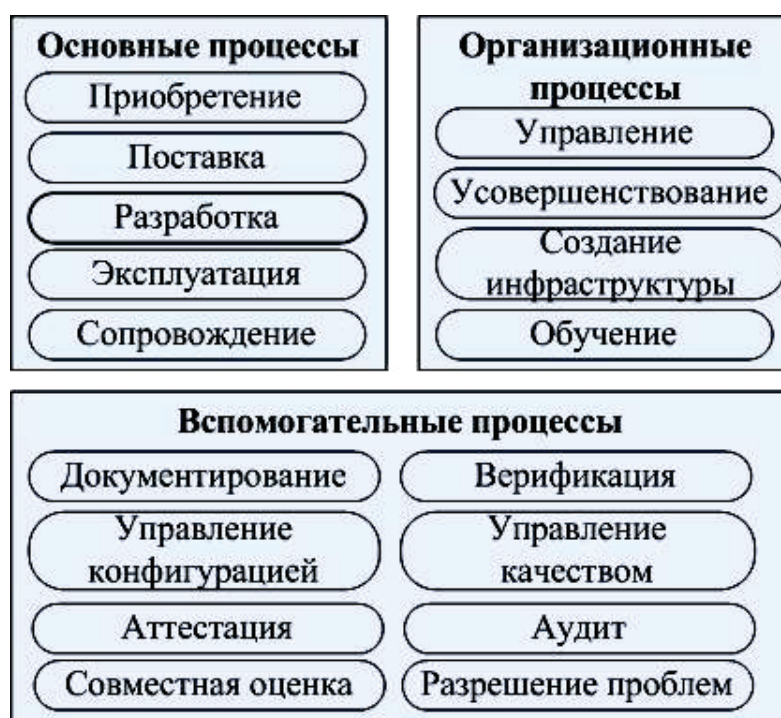
Рис. 8. Процессы жизненного цикла программного обеспечения по ISO 12207
