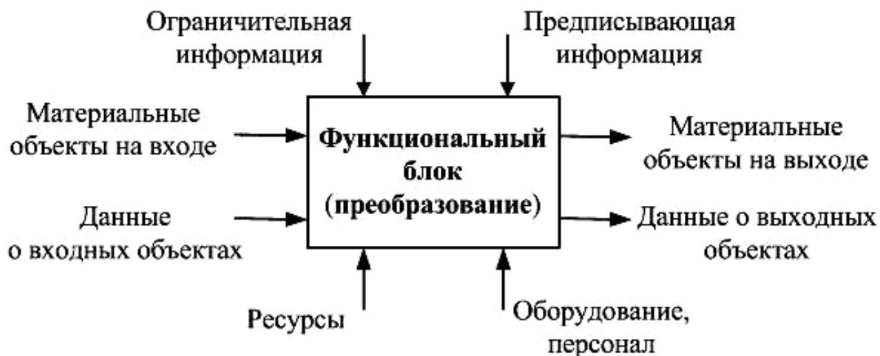
Рис. 12. Функциональный блок модели IDEF0
