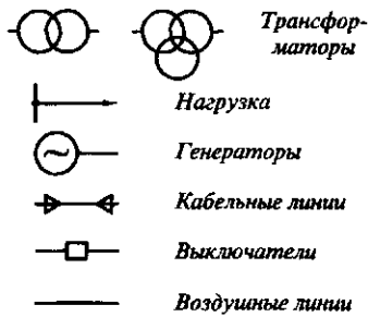
Рис. 1.1. Условные обозначения элементов электрической системы
