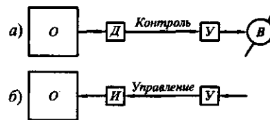
Рис. 20.4. Структурные схемы автоматических систем: a – контроля; б – управления; В – воспроизводящий орган
