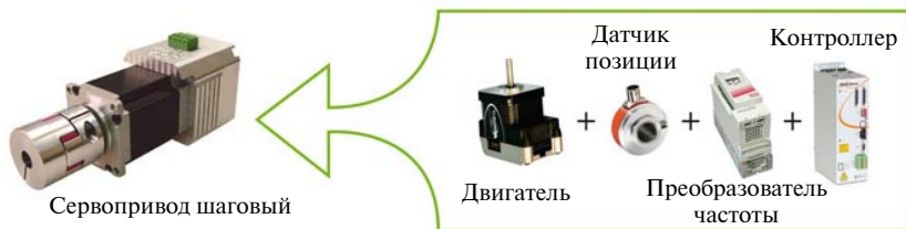
Рис. 3.4. Схема гибридизации привода СПШ 10
