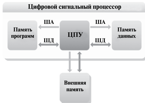
Рис. 3.6. Гарвардская архитектура DSP
