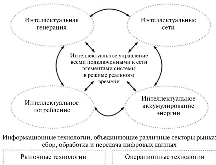
Рис. 4.52. Программа E-Energy (Германия): компоненты программы
