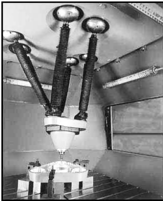
Рис. 4.27. Вид снизу на конструкцию платформы стенда-имитатора
