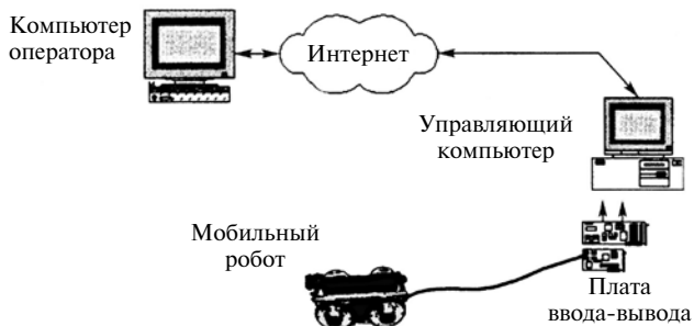
Рис. 4.48. Управление мобильным роботом «ИРИС-1» по сети Интернет
