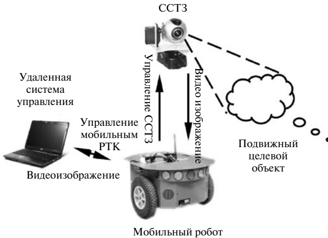
Рис. 4.42. Общая структура мобильного РТК
