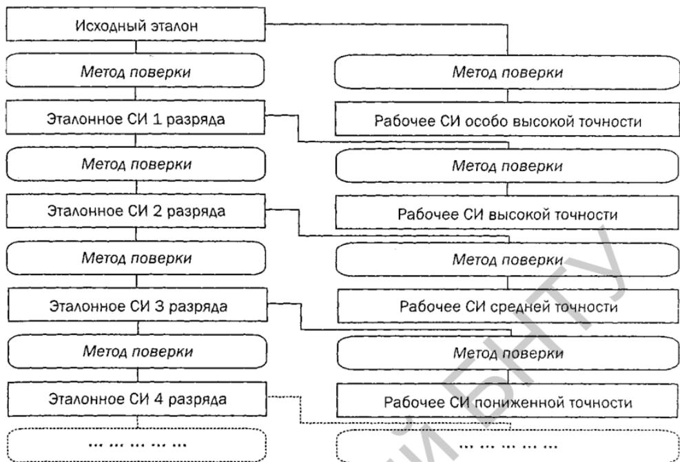
Рис. 2.10. Общая структура поверочной схемы
