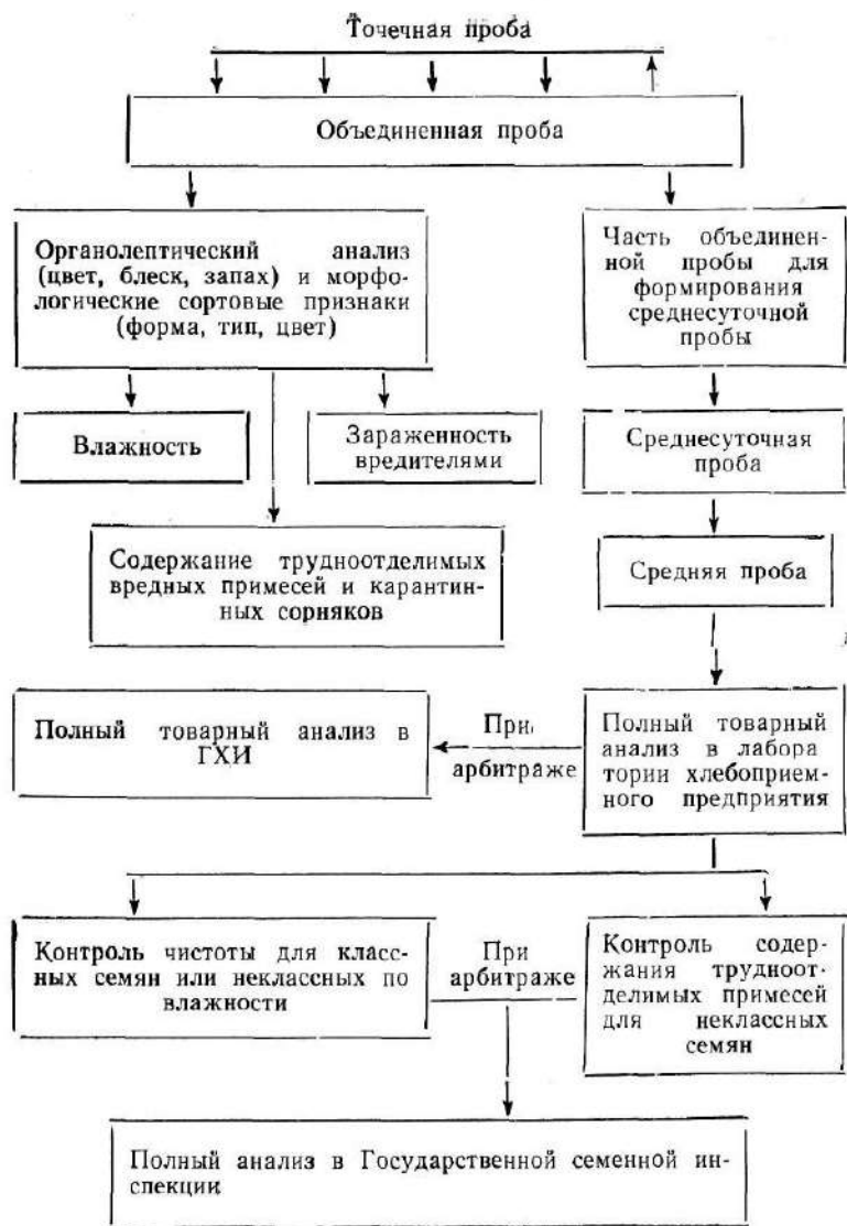
Рис. 35. Схема проведения лабораторного анализа семян при поступлении их на хлебоприемное предприятие.
