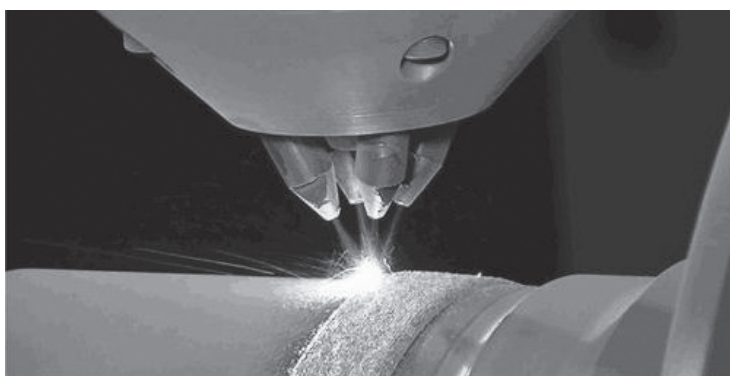
Рис. 2.4. 3D-печать металлической детали
