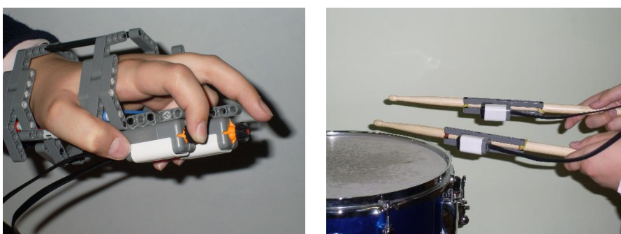
Рис. 8.103. Конструкции для управления роботом-барабанщиком: слева — на датчиках касания, справа — на гироскопических датчиках.
