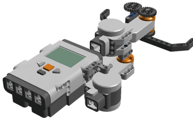
Рис. 8.152. Мотор с захватом закрепляется на диске первого мотора.
