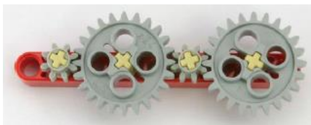
Рис. 2.8. Две промежуточные шестерни — паразитные [3].
