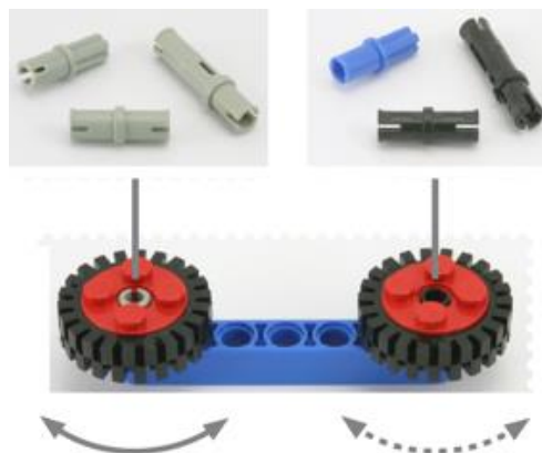
Рис. 2.4. Серые штифты и бежевые штифты-полуоси предназначены для вращения, а черные и синие – для фиксации [3].
