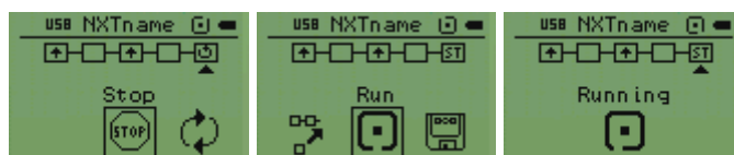
Рис. 3.2. Остановка моторов с помощью команды Stop в конце программы.
