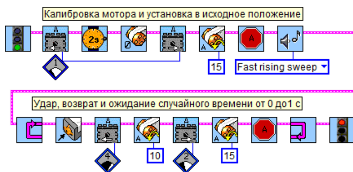
Рис. 8.100. Управление палочкой с помощью датчика касания.
