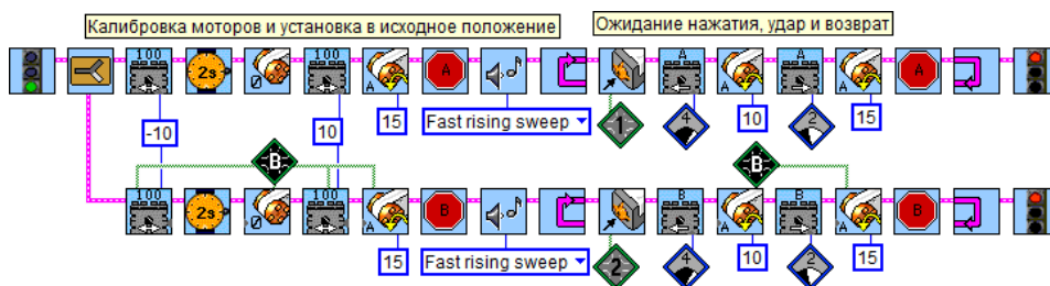
Рис. 8.102. Алгоритм управления палочками с помощью двух датчиков.
