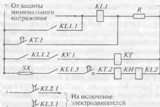
Рис. 10.4. Принципиальная схема устройства АПВ электродвигателей напряжением 6 или 10 кВ
