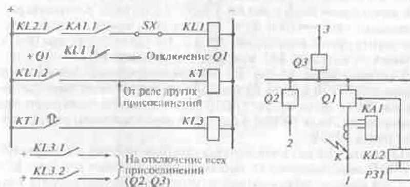
Рис. 12.4. Принципиальная схема УРОВ с дополнительным контролем по току
