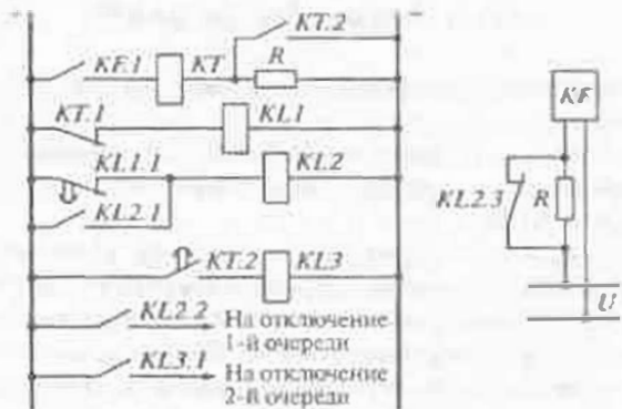
Рис. 11.3. Схема АЧР с двумя очередями
