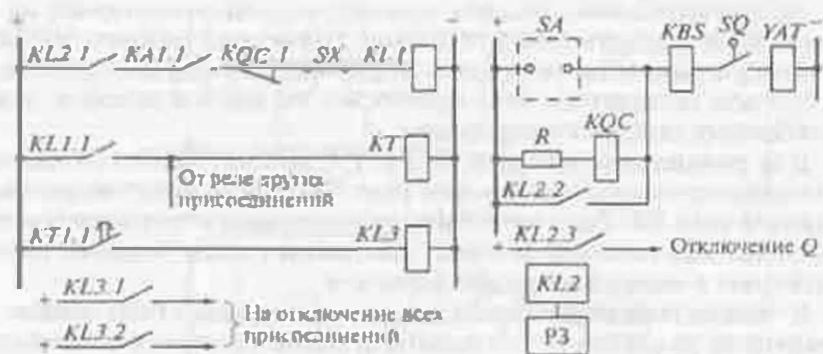
Рис. 12.5. Принципиальная схема УРОВ с использованием реле положения «Включено»
