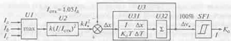
Рис. 15.7. Функциональная схема цифровой защиты от перегрузок.
