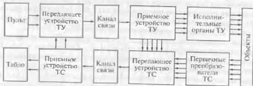
Рис. 14.3. Структурная схема системы ТУ—ТС для сосредоточенных объектов
