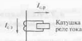
Рис. 2.3. Ток срабатывания защиты и ток срабатывания реле
