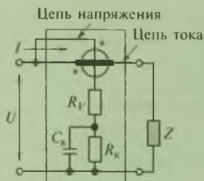
Рис. 3.12. Схема ваттметра электродинамической системы
