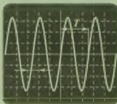
Рис. 4.30. Измерение периода сигнала:
