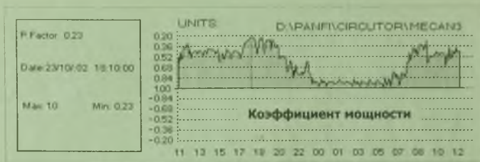
Рис. 2.10. Изменения коэффициента мощности
