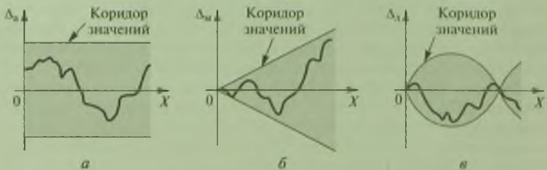
Рис. 1.7. Зависимость погрешностей от значения измеряемой величины X : а — аддитивная погрешность; б — мультипликативная погрешность; в — погрешность линейности
