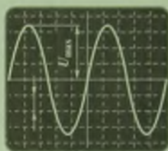
Рис. 4.29. Измерение амплитуды сигнала:
