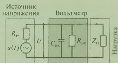
Рис. 1.16. Погрешность взаимодействия прибора и источника периодического напряжения
