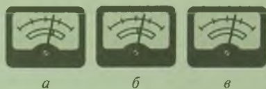
Рис. 1.20. Устранение погрешности параллакса:
