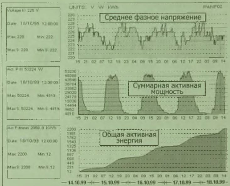
Рис. 7.21. Пример длительной регистрации параметров трехфазной электрической сети
