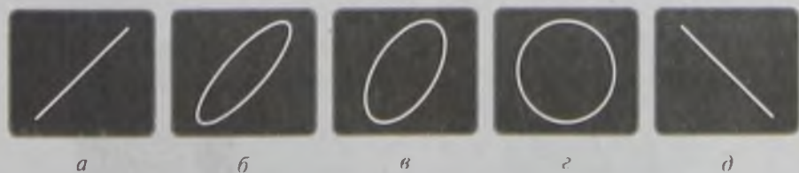
Рис. 4.11. Изображения на экране в методе эллипса для разных значений фазового сдвига:
