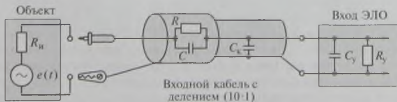
Рис. 4.22. Подключение входного кабеля с делением
