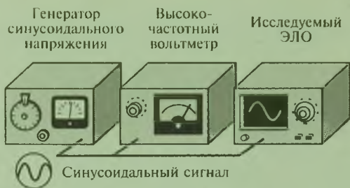
Рис. 4.17. Экспериментальное определение АЧХ канала ЭЛО
