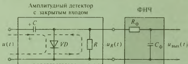
Рис. 3.23. Амплитудный детектор с закрытым входом
