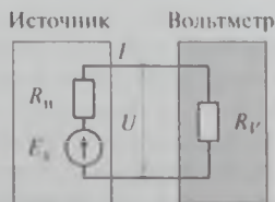
Рис. 1.14. Погрешность взаимодействия вольтметра и источника напряжения
