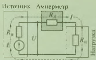
Рис. 1.15. Влияние амперметра на ток в цепи
