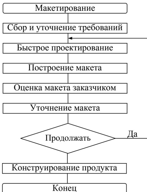
Рис. 1.13. Последовательность действий при макетировании
