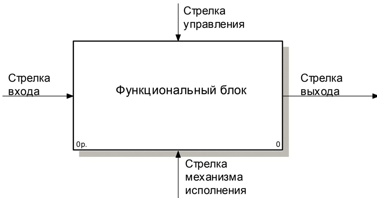
Рис. 2.19. Соединение стрелок со сторонами функционального блока
