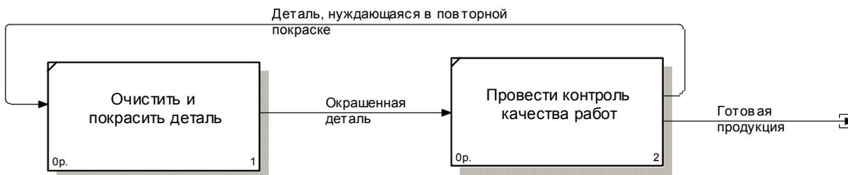
Рис. 2.24. Комбинированная стрелка «Выход – обратная связь на вход»
