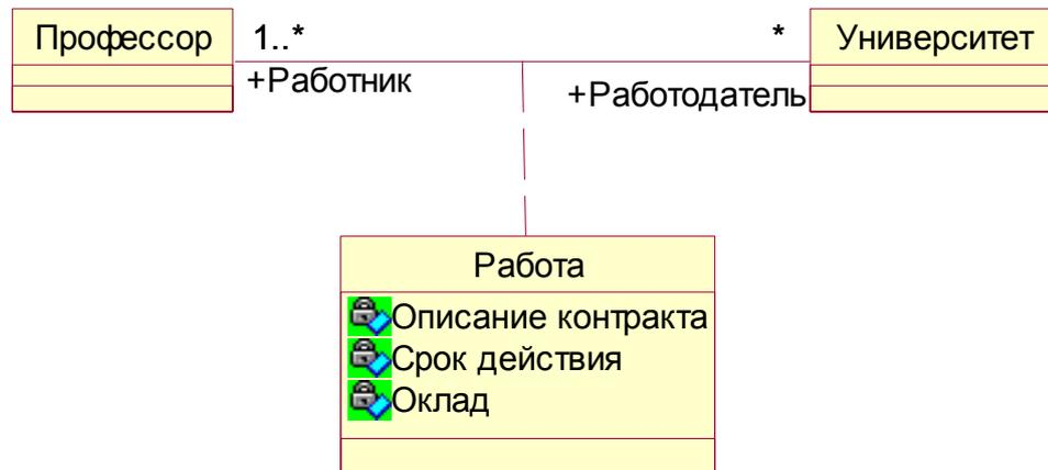
Рис. 1.6. Структура объектно-ориентированной программы в виде связанных классов
