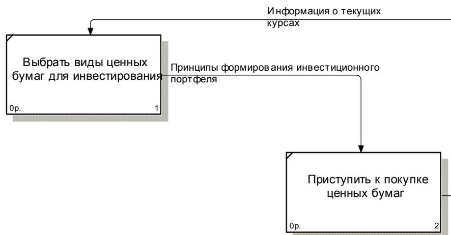
Рис. 2.23. Комбинированная стрелка «Выход – обратная связь на управление»
