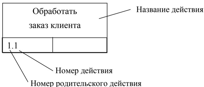
Рис. 2.8. Изображение и нумерация действия в диаграмме IDEF3
