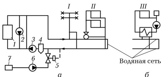
**Рис. 1.11.** Структурная схема районного теплоснабжения от водогрейной котельной:
