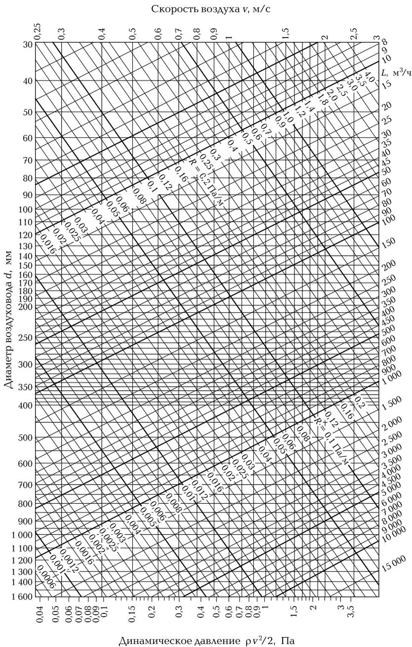
Рис. 7.8. Номограмма для расчета круглых стальных воздуховодов
