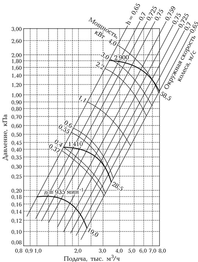
Рис. 8.3. Аэродинамическая характеристика вентилятора ВЦ4-70 № 4
