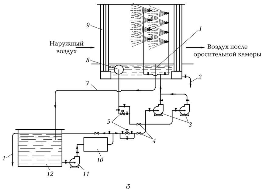
**Рис. 9.8.** Схемы устройства водяной сети кондиционера:
