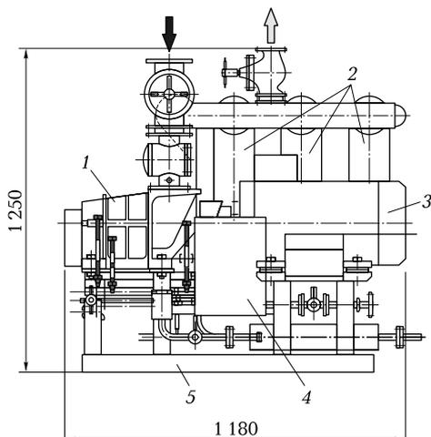
**Рис. 9.16.** Общий вид аммиачного компрессорного агрегата 2A50B-7:
