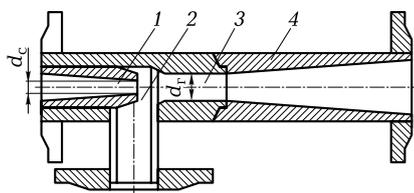
**Рис. 3.13.** Водоструйный элеватор:
