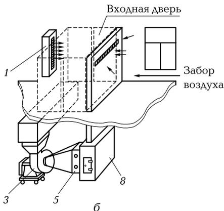
**Рис. 3.23.** Способы размещения оборудования тепловых воздушных завес:
