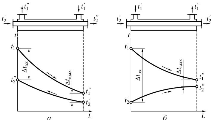
**Рис. 1.7.** Схема движения и график изменения температур теплоносителей:
