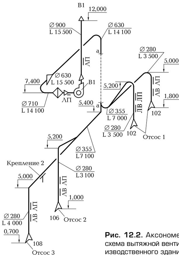
**Рис. 12.2.** Аксонометрическая схема вытяжной вентиляции производственного здания
