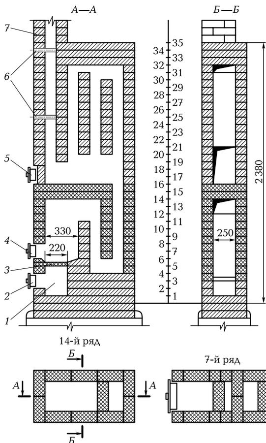
**Рис. 3.26.** Конструкция толстостенной печи ОПЗ-3:
