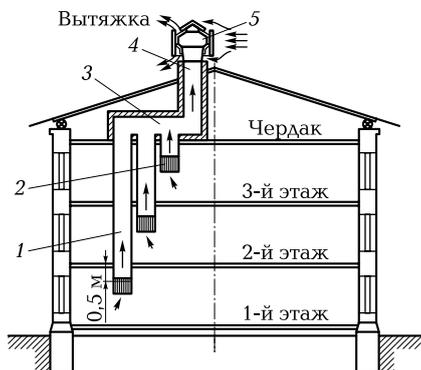
**Рис. 7.6.** Канальная система вытяжной вентиляции с естественным побуждением:
