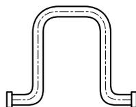
**Рис. 1.17.** П-образный компенсатор
