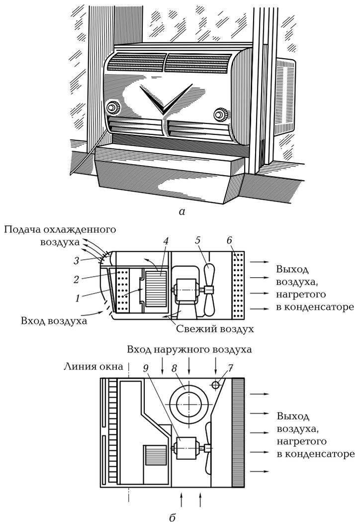
**Рис. 9.14.** Оконный кондиционер со встроенной холодильной машиной:
