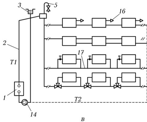
**Рис. 3.4.** Однотрубные системы водяного отопления с принудительным побуждением:
