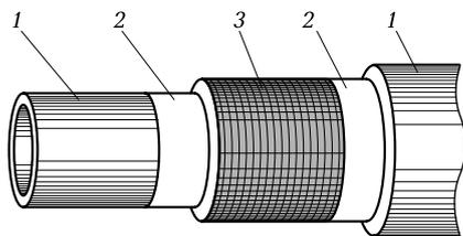
ность; удобство транспортирования; технологичность монтажа — трубы легко гнутся, позволяют огибать элементы помещений, не требуется точная подгонка линейных размеров, монтаж выполняется непосредственно (без сварки, нарезки резьбы) с оборудованием и приборами из стали, латуни, пластмасс при помощи соединительных деталей.
