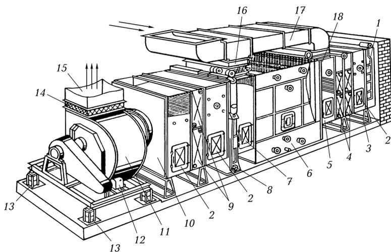
**Рис. 9.6.** Общий вид центрального форсуночного кондиционера типа КТЦ;
