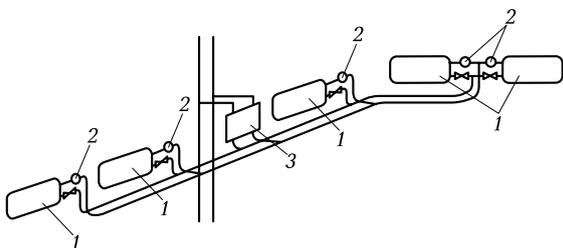
**Рис. 5.7.** Система отопления с горизонтальными двухтрубными ветками для параллельно-последовательно подсоединенных отопительных приборов: 1 — отопительные приборы; 2 — встроенные терморегуляторы; 3 — поквартирный тепловой пункт
