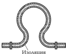
**Рис. 1.16.** Лирообразный компенсатор
