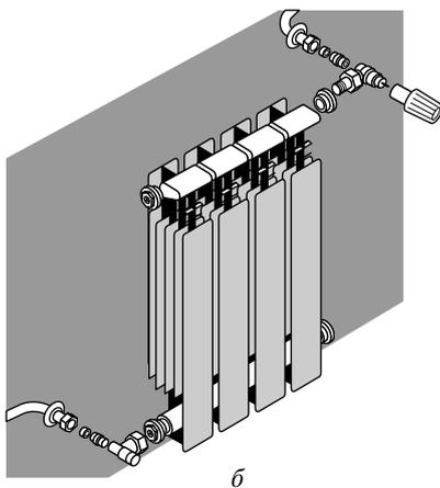
**Рис. П4.** Подключение радиатора по схеме «по диагонали» на угловых вентилях:
