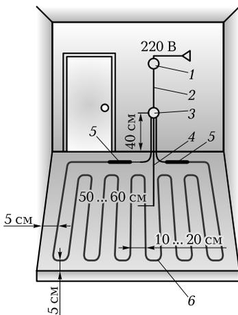
**Рис. 3.30.** Схема установки нагревательной секции и размещения терморегулятора:
