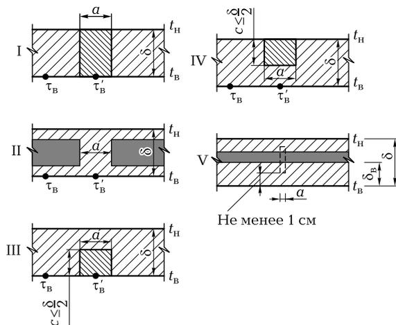
**Рис. 2.3.** Варианты схем теплопроводных включений в ограждающие конструкции
