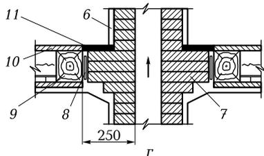
Если применяют круглые дымовые каналы, то площадь их сечения должна быть не менее площади указанных прямоугольных каналов для соответствующей мощности печи.
