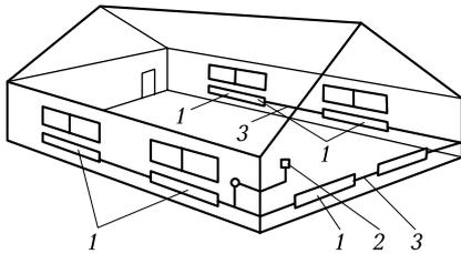
**Рис. 3.31.** Эскиз размещения электроконвекторов в жилом помещении:
