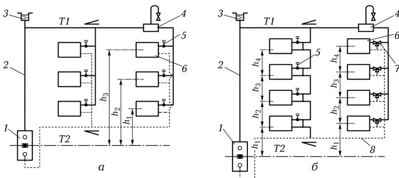
**Рис. 3.8.** Системы водяного отопления с естественным побуждением: а — двухтрубная; б — однотрубная; 1 — котел; 2 — главный стояк; 3 — расширительный бак; 4 — воздухоотделитель; 5 — кран двойной регулировки; 6 — отопительный прибор; 7 — трехходовой регулировочный кран; 8 — обратная магистраль
