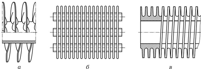
**Рис. 8.5.** Виды оребрения caloriferов:
