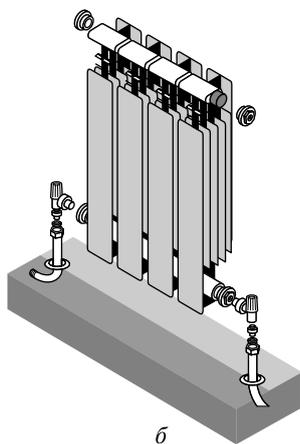
**Рис. ПЗ.** Подключение радиатора по схеме «снизу вниз»:
