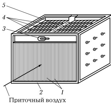
**Рис. 11.4.** Пленочно-контактная кассета для обработки приточно-вентиляционного воздуха:
