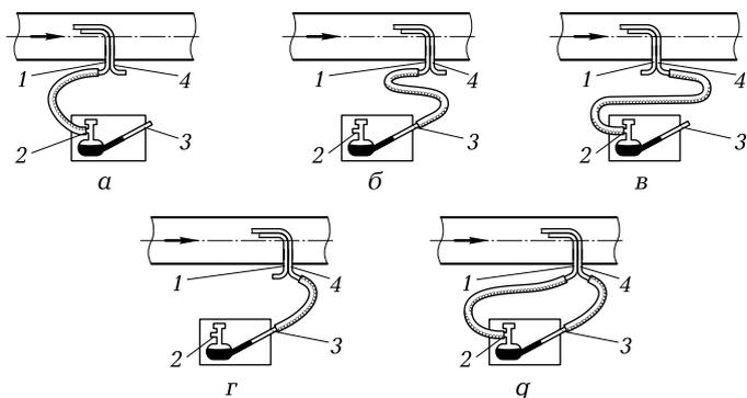
**Рис. 10.4.** Схемы присоединения пневмометрической трубки к напорному при замерах давления:
