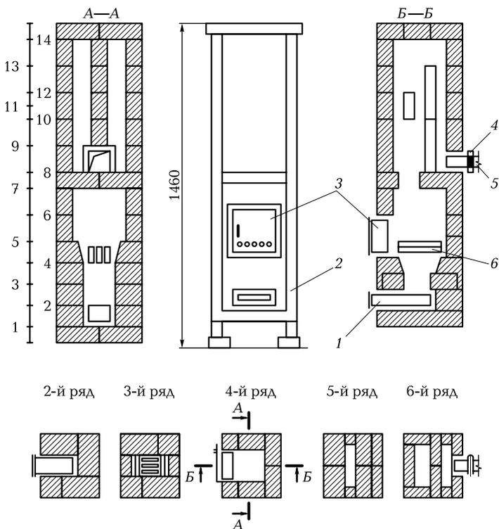
**Рис. 3.25.** Конструкция тонкостенной печи MBMS-61:
