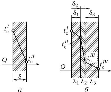
**Рис. 1.3.** Передача теплоты через плоскую стенку:
