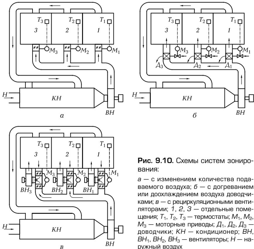
**Рис. 9.10.** Схемы систем зонирования:
