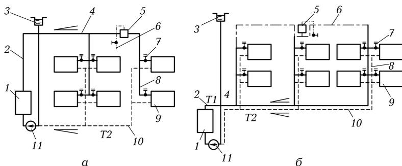
**Рис. 3.3.** Двухтрубные системы водяного отопления с принудительным побуждением:
