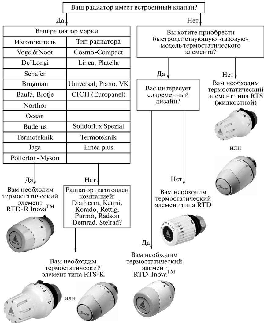
Рис. П6. Выбор термостатического элемента
