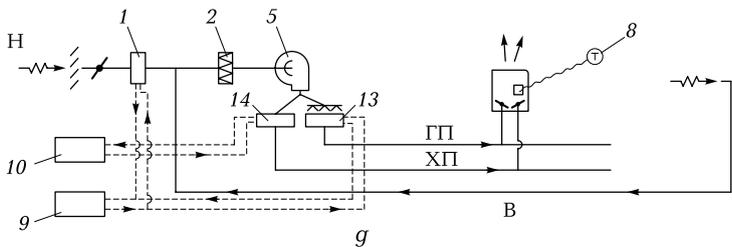
этих помещений лишь в незначительной степени обусловлены воздействием воздушного потока, поступающего с центральной станции обработки. Основная часть теплообмена в помещениях приходится на долю теплой или охлажденной воды, циркулирующей либо в змеевике всасывающего устройства, либо в излучающей панели.
