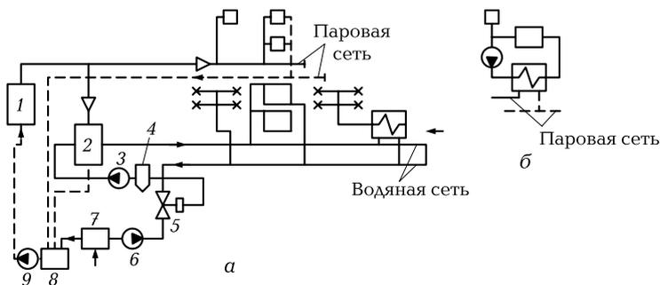
**Рис. 1.12.** Структурная схема районного теплоснабжения от паровой котельной:
