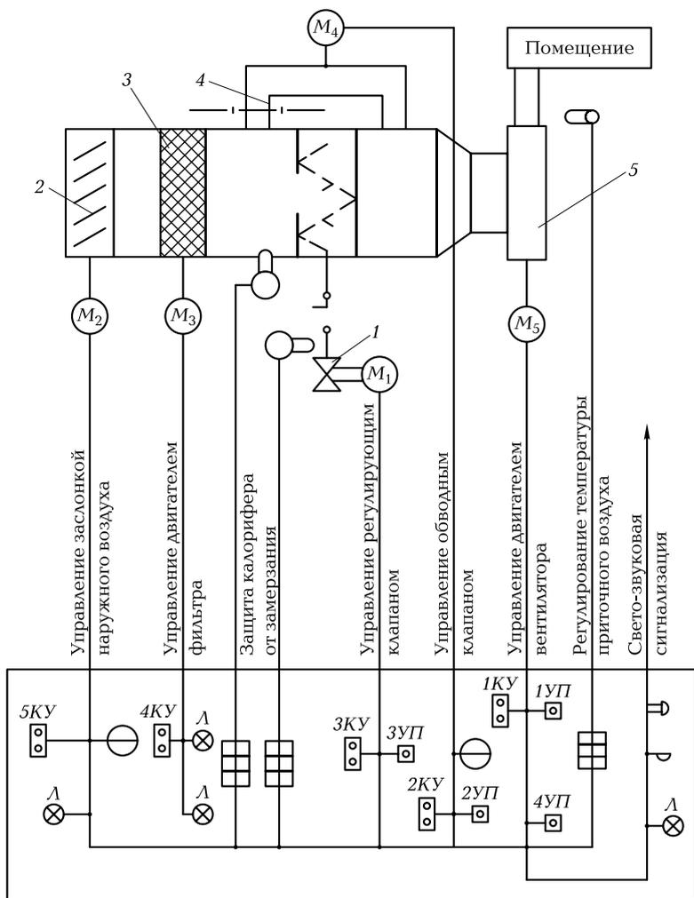
**Рис. 11.8.** Принципиальная схема автоматического управления вентиляционной системой:
