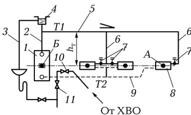
1 — котел; 2 — главный стояк; 3 — переливная труба; 4 — расширительный бак; 5 — подающая магистраль; 6 — отопительные стояки; 7 — краны двойной регулировки; 8 — отопительный прибор; 9 — обратная магистраль; 10 — кран для заполнения системы водой; 11 — кран для опорожнения системы; А — центр охлаждения в отопительном приборе; Б — центр нагревания в котле
