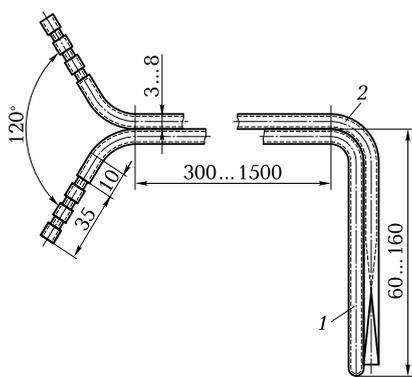
**Рис. 10.3.** Пневмометрическая трубка
