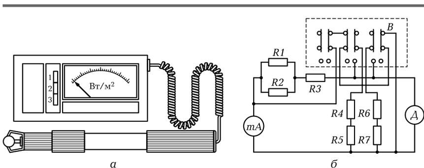
**Рис. 10.9.** Измеритель тепловых потерь ИТП-6:
