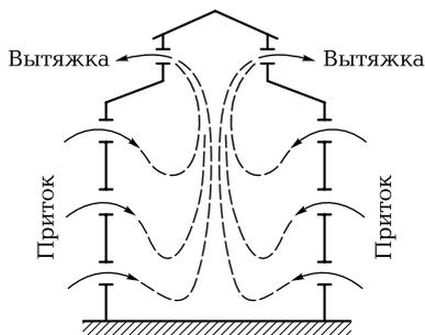
**Рис. 7.1.** Движение воздушных потоков при естественной вентиляции здания
