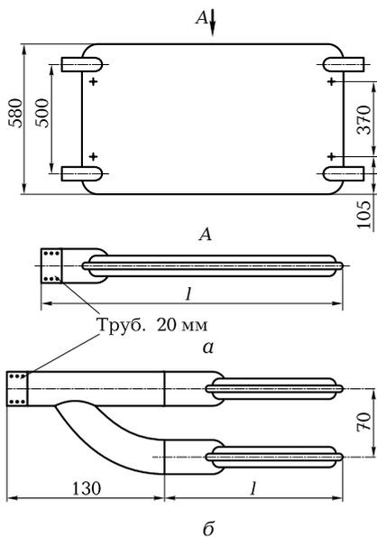
**Рис. 4.3.** Стальные панельные штампованные радиаторы типа РСВ:
