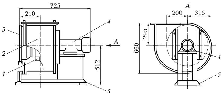
**Рис. 8.2.** Общий вид радиального (центробежного) вентилятора типа ВЦ4-70 № 4:
