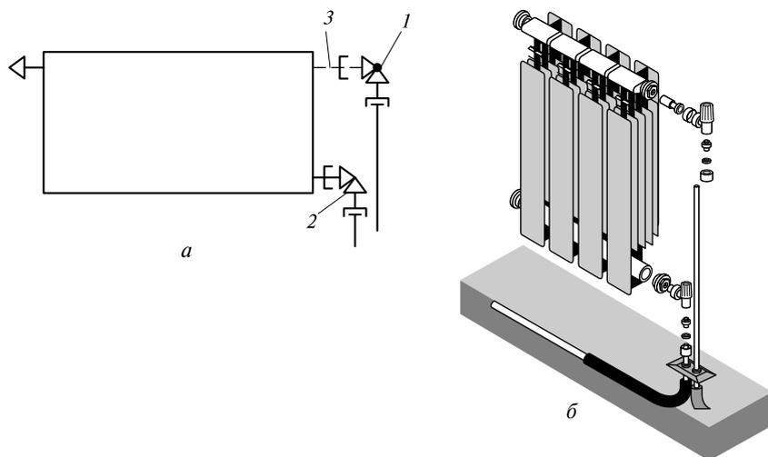
**Рис. П1.** Одностороннее подключение радиатора с выходом труб из пола: *а* — схема; *б* — общий вид; 1 — терморегулирующий вентиль; 2 — запорный вентиль; 3 — фитинг
