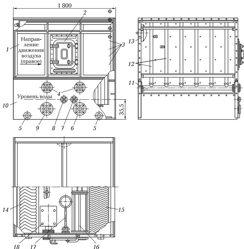
**Рис. 9.7.** Двухрядная камера орошения:
