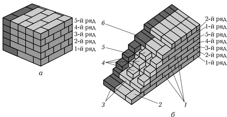
**Рис. 2.1.** Конструкция кладки из утолщенного кирпича «Термолюкс®»:
