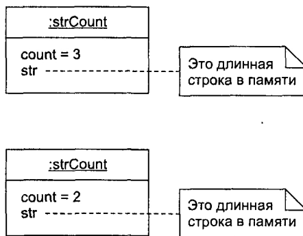
Рис. 11.4. Объектная диаграмма UML: дублирование строк
