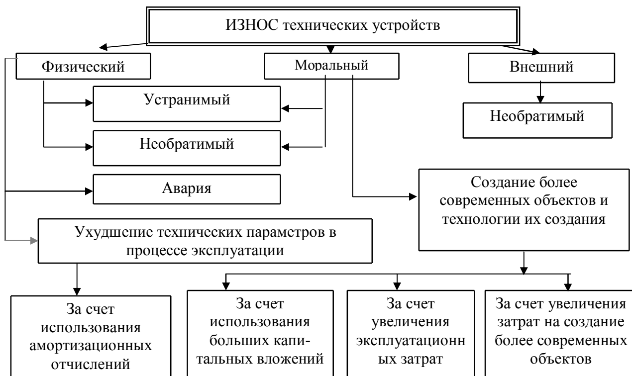
Рис. 3.1. Виды, причины возникновения и пути устранения износа технических устройств
