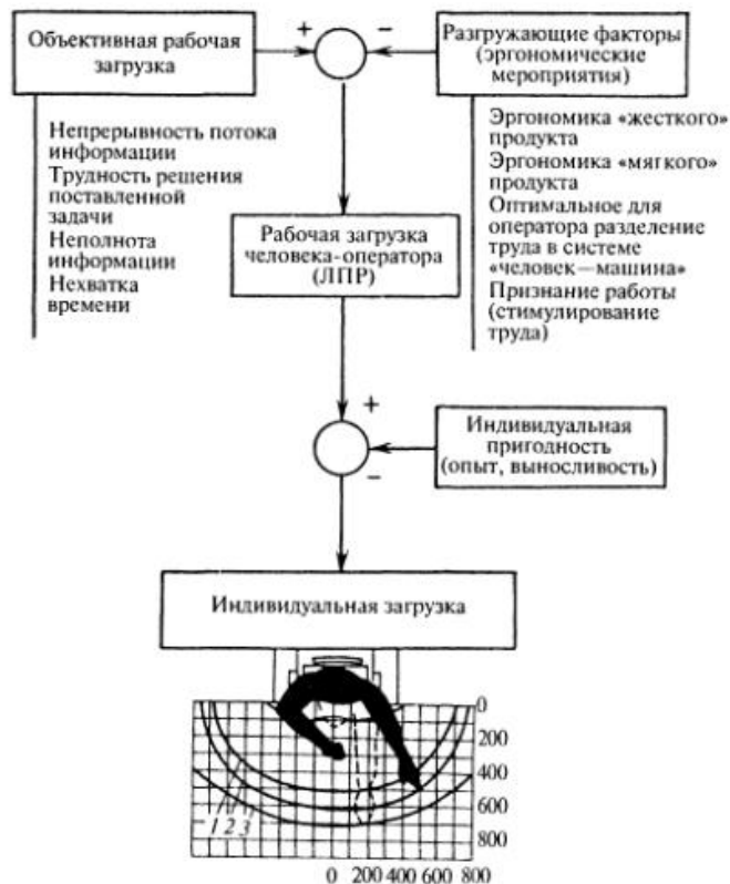
Рис. 4.7. Формирование нагрузки оператора в процессе управления на рабочем месте: Зоны досягаемости оператора в горизонтальной плоскости: 1 — оптимальная; 2 — допустимая; 3 — максимальная
