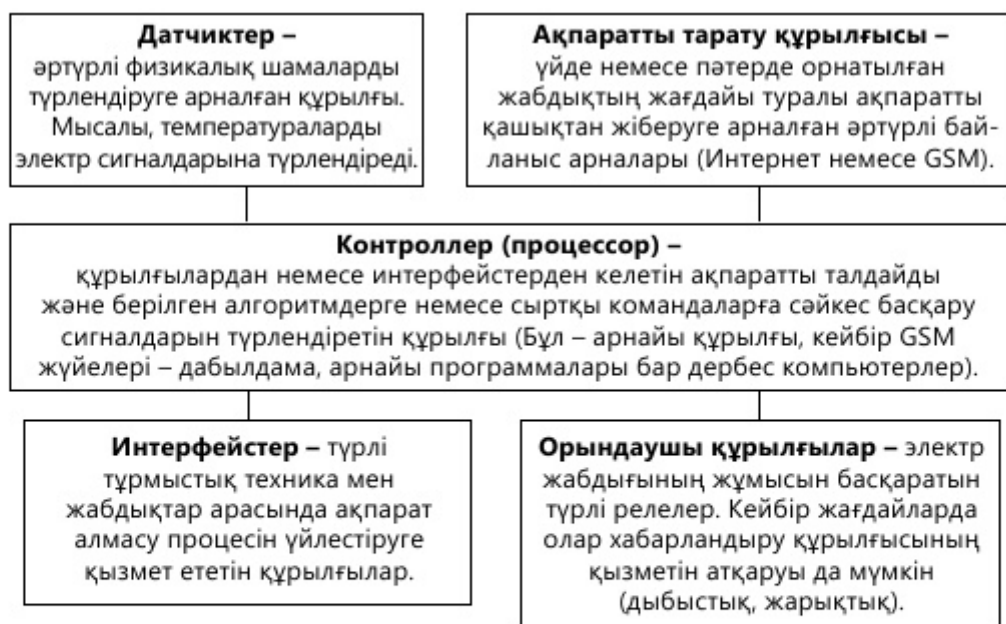
4.2.2-сурет. Құрылғының құрылымдық сызбасы және қызметтік мақсаты
