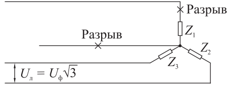
Рис. 10.14. Распределение потенциалов в линии при разрыве проводов.
