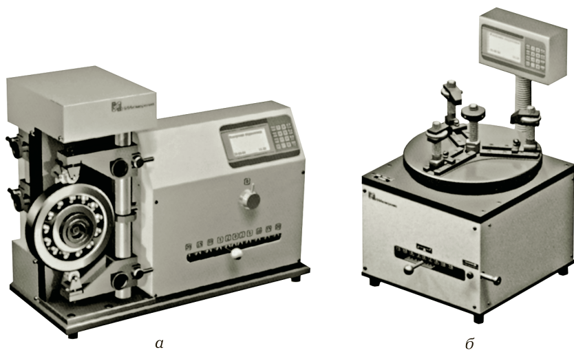
Рис. 4.19. Приспособления для контроля радиальных [а] и осевых [б] зазоров подшипников
