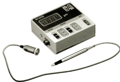
Рис. 4.20. Портативная измерительная система с индуктивным преобразователем
