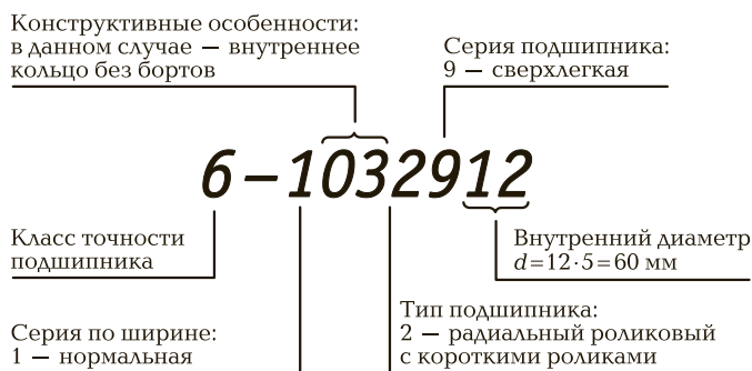
Рис. 4.17. Условное обозначение подшипников качения
