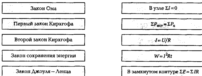
Рис. 1.20. Схема, отражающая связь названий и формул основных законов электротехники (к задаче 13 подразд. 1.2)
