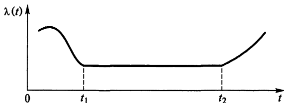
Рис. 2.2. Типичная зависимость интенсивности отказов изделия от времени эксплуатации
