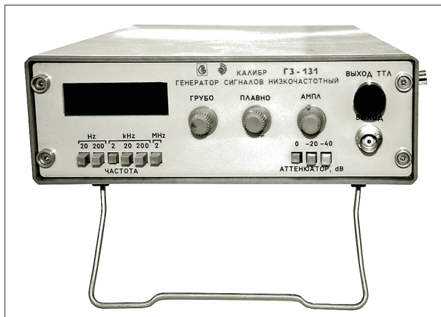
Рис. 5.22. Внешний вид генератора ГЗ-131
