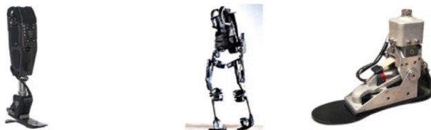
(а) Бионический протез БИНК, ИНЭУМ им. И.С. Брука (б) Экзоскелет Ekso Bionics (в) Протез ступни iWalk PowerFoot One
