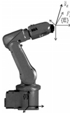
Рис. 1.5. Системы координат манипулятора в операционном пространстве: \{I\} – инерциальная (базовая) система координат, \{E\} – система координат, "прикрепленная" к рабочему инструменту манипулятора
