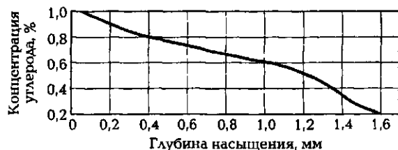
Рис. 14.1. Концентрация углерода в зависимости от глубины насыщения
