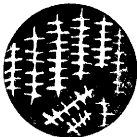
Рис. 15.1. Эскиз микроструктуры однофазной латуни (марка П70)
