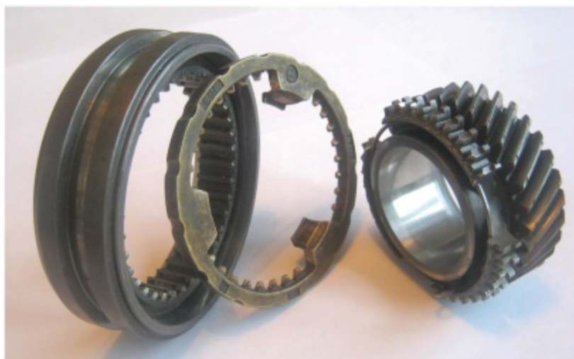
Рис. 41. Синхронизатор с блокирующим зубчатым венцом и пружинным кольцом, взаимодействующим со скосами трех выступов блокирующего кольца
