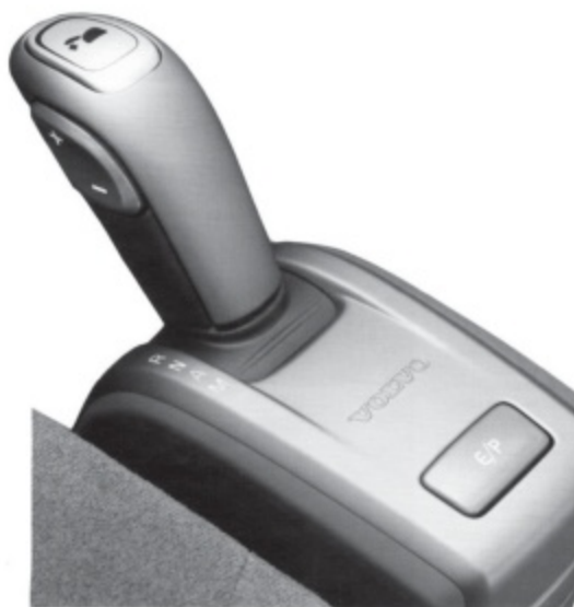
Рис. 63. Рычаг управления роботизированной коробки передач с позицией ручного последовательного переключения
