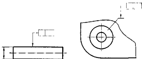
Рис. 3.28. Пример нормирования геометрического допуска, который относится к полному элементу
