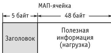
Рис. 6.11. Структура МАП-ячейки
