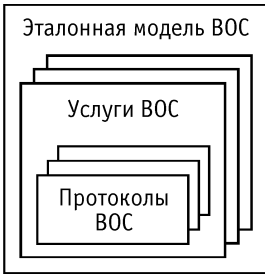
Рис. 9.13. Структура разработки стандартов для ВОС
