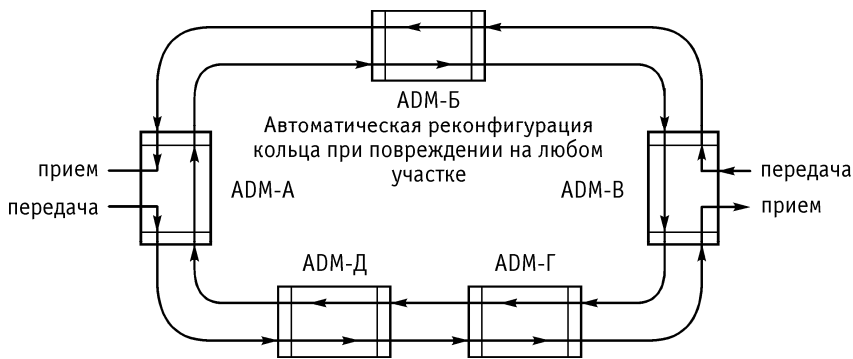
Рис. 8.9. Двухнаправленное кольцо с защитой секции мультиплексирования
